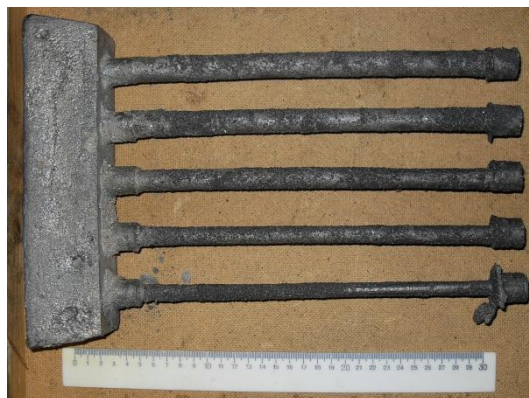
Рис. 1. Вид образца пробы горячие трещины
