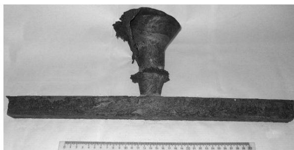
Рис. 2. Образец пробы на линейную усадку
