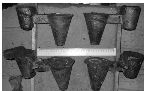
Рис. 3. Общий вид проб для определения объемной усадочной раковины
