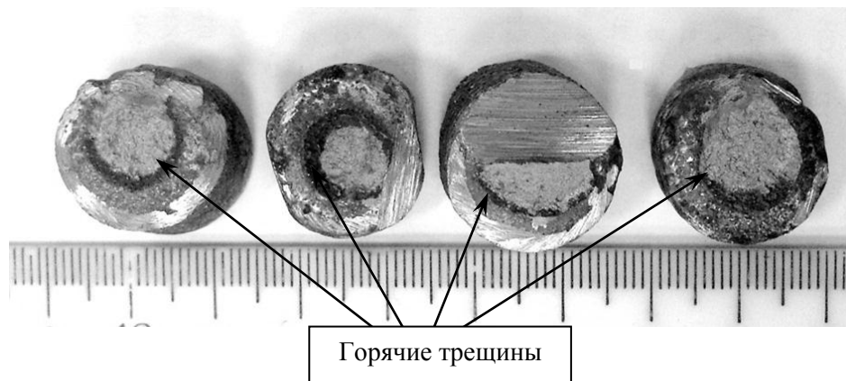
Рис. 5. Горячие трещины в образцах диаметром 10 и 12 мм из стали марки 12Х18Н12М3ТЛ
