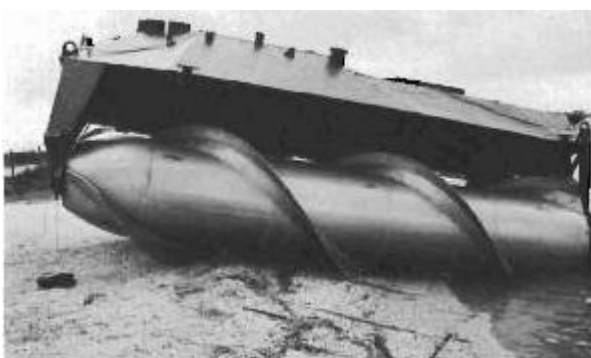
Рис. 26. Роторно-винтовые машины Riverine Utility Craft (1969 г.)
