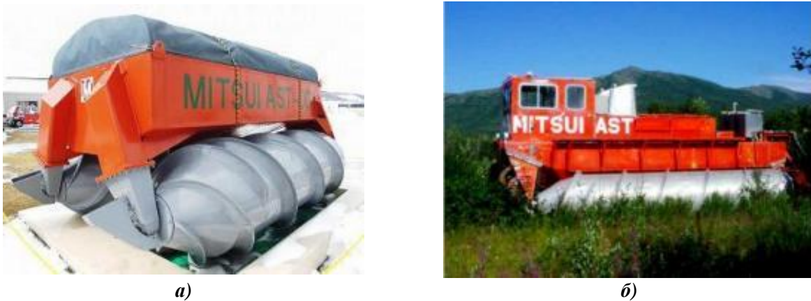
Рис. 28. Японские машины, оснащенные РВД Archimedean Screw Tractor Фирмы Mitsui Engineering & Shipbuilding: а – AST-001; б – AST-002
