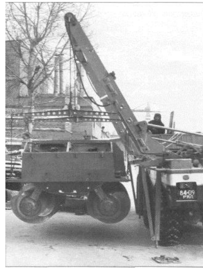
Рис. 47. Транспортировка и разгрузка машины на РВД – ЗиЛ-2906
