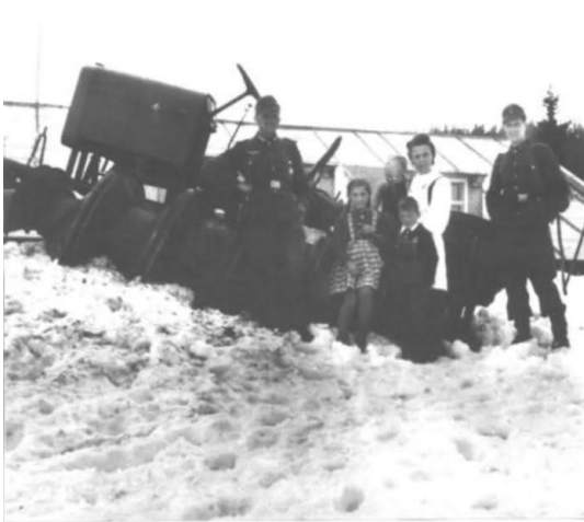
Рис. 17. Боевая машина Вермахта, оснащенная роторно-винтовым движителем (1941–1945 гг.)
