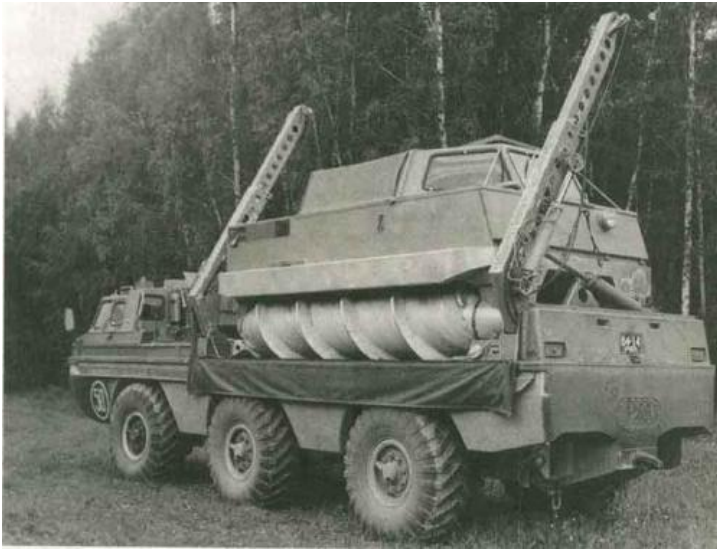
Рис. 47. Транспортировка и разгрузка машины на РВД – ЗиЛ-2906
