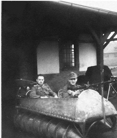
Рис. 17. Боевая машина Вермахта, оснащенная роторно-винтовым движителем (1941–1945 гг.)
