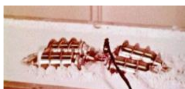
Рис. 52. Модели машин на РВД, разработанные и испытанные М.Г. Беккером (1961 г.)
