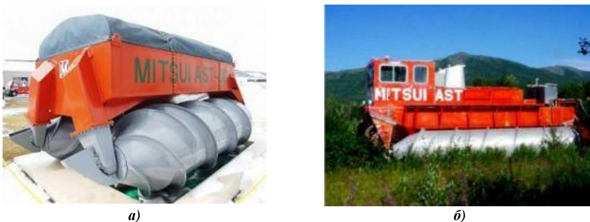
Рис. 28. Японские машины, оснащенные РВД Archimedean Screw Tractor Фирмы Mitsui Engineering & Shipbuilding: а – AST-001; б – AST-002
