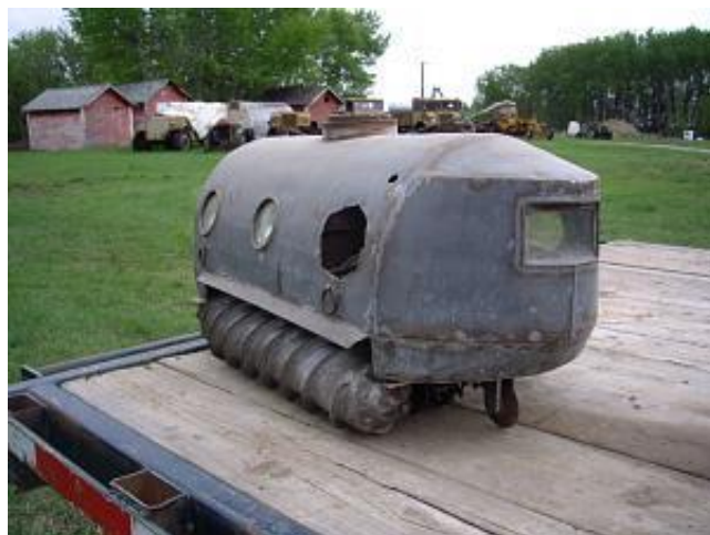
Рис. 12. Жестяная модель плавающего танка Коди со шнековым движителем (Канада, 1918 г.)
