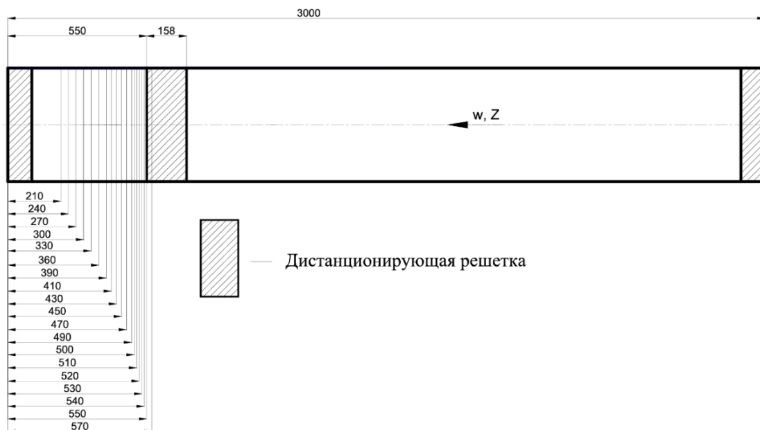
Рис. 5. Схема расположения сечений измерения гидродинамических характеристик по длине ЭМ
