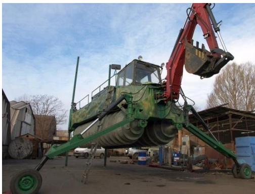
Рис. 48. «Земснаряд-шнекоход» с технической системой саморазгрузки с транспортной платформы (Украина, Днепропетровск 2015 г.)
