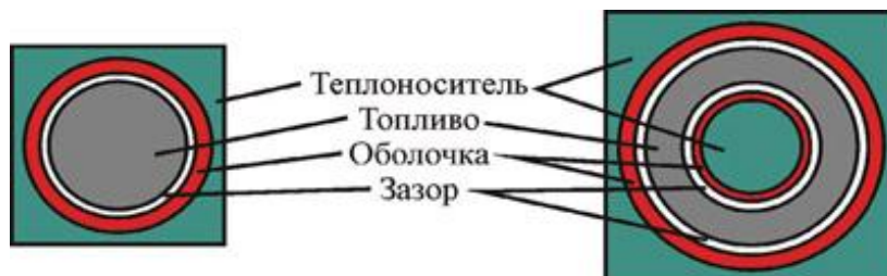
Рис. 1. Конструкция кольцевого и стержневого ТВЭЛ
