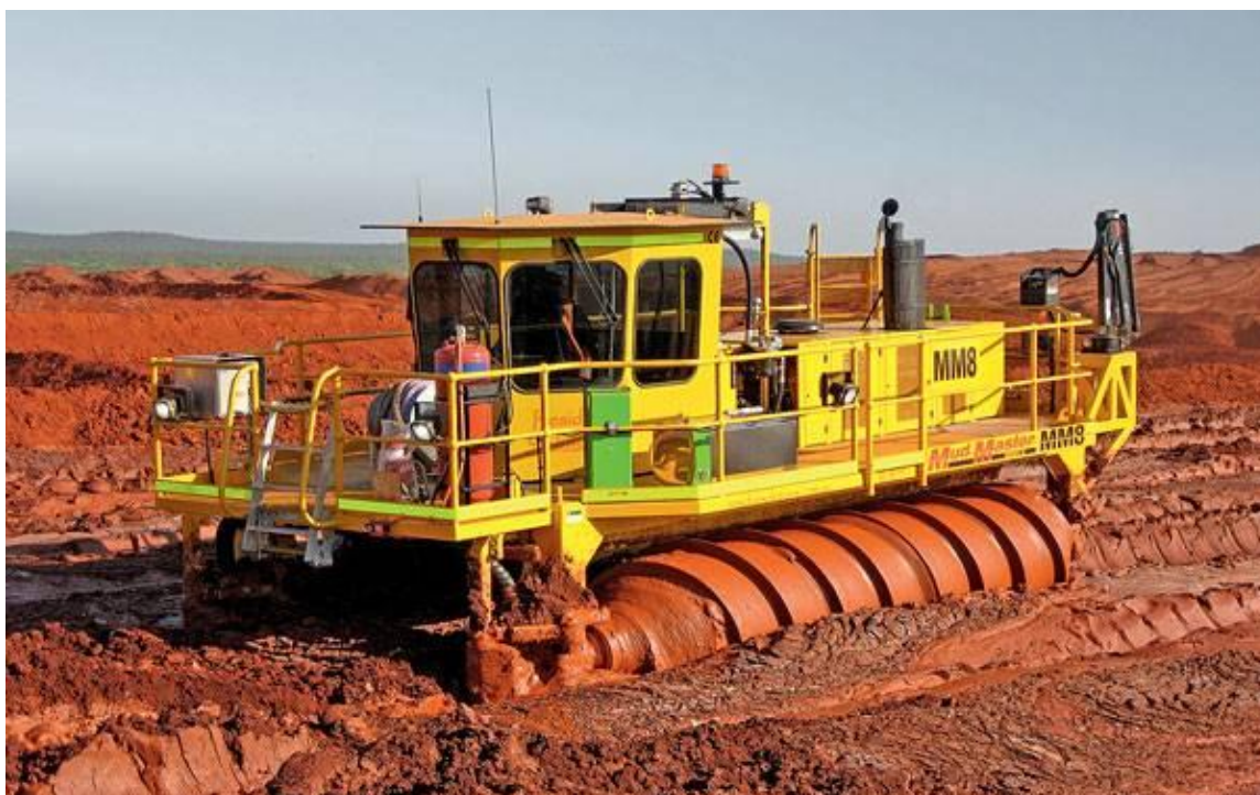
Рис. 45. MudMaster от австралийской компании Residue Solutions - единственный на сегодняшний день шнекоход, собирающийся серийно
