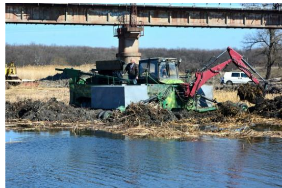
Рис. 48. «Земснаряд-шнекоход» с технической системой саморазгрузки с транспортной платформы (Украина, Днепропетровск 2015 г.)
