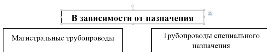
Рис. 3. Классификация трубопроводов в зависимости от назначения
