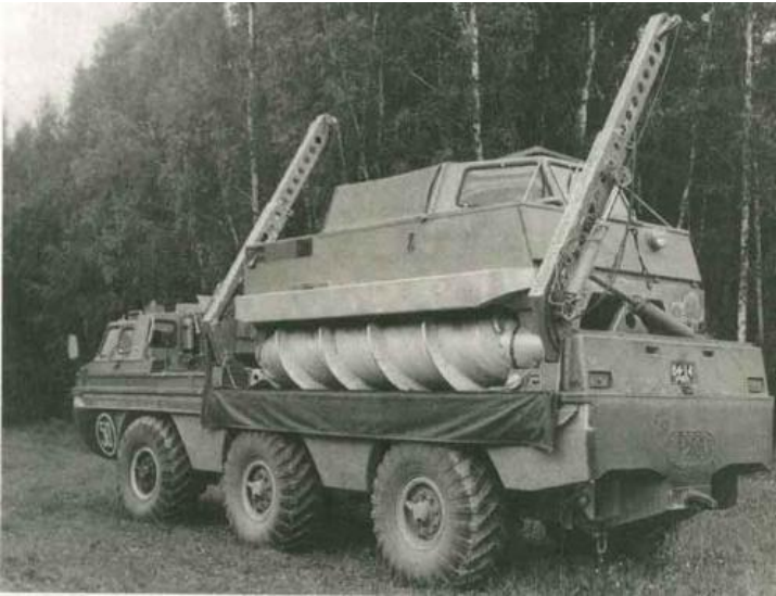
Рис. 47. Транспортировка и разгрузка машины на РВД – ЗиЛ-2906
