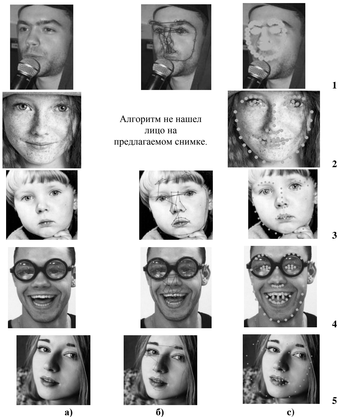
Рис. 3. Качественное сравнение работы алгоритмов: а – оригинал; б – ААМ; в – CLM
