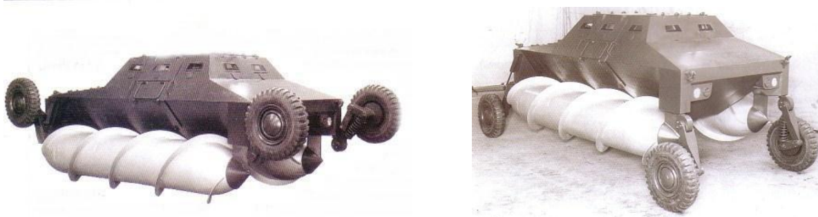
Рис. 27. Модель транспортного средства фирмы Chrysler, оснащенного комбинированным двигателем
