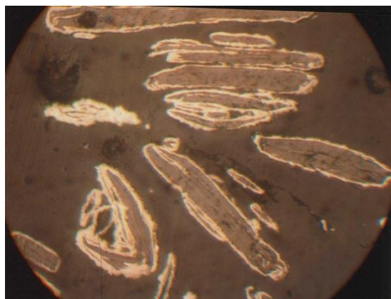
Рис. 6. Структура частиц порошка НПГ-80. В центре частиц расположен графит, окруженный слоем никеля толщиной 9 мкм. Увеличение 130
