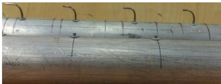
Рис. 1. Общий вид твэл-имитаторов с устройствами отбора трассера
