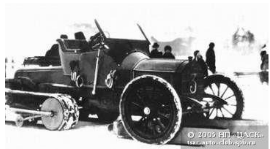
Рис. 51. Адольф Кегресс в Царскосельском императорском гараже на автомобиле Мерседес14-30 с гусеничным двигателем собственной конструкции. 1912 г.
