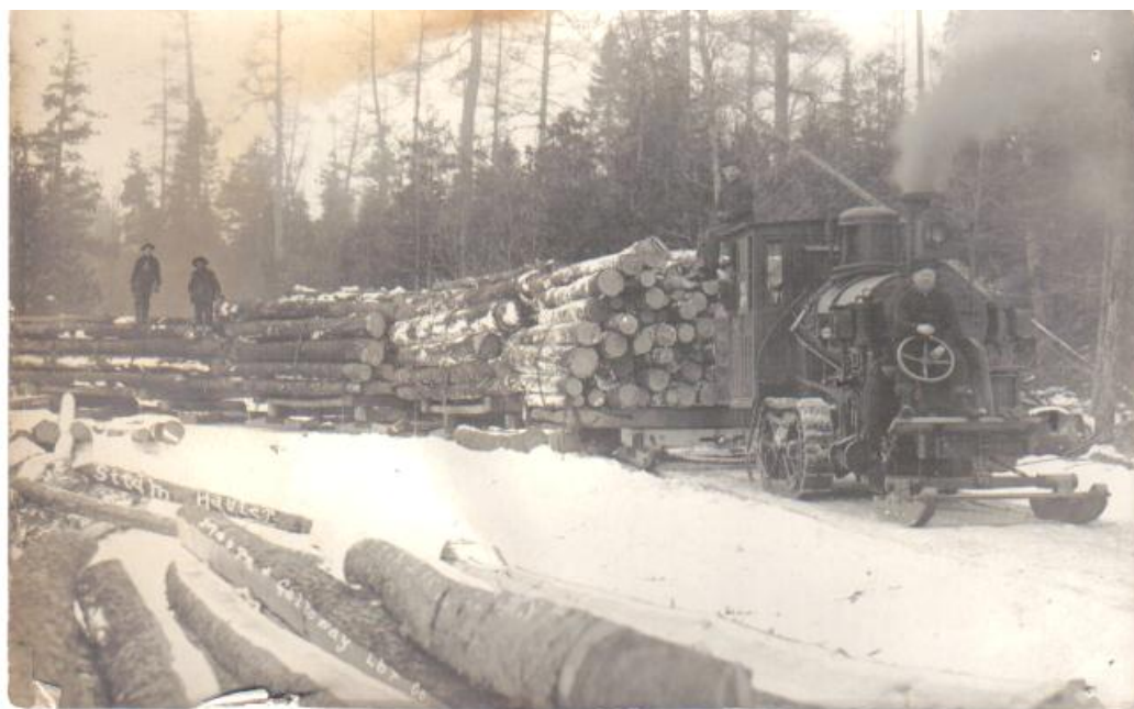
Рис. 26. «Lombard Log Hauler» на лесозаготовках (1901-1914 гг.)
