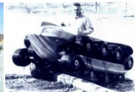
Применение катково-гусеничного движителя на вездеходе типа Джигер
