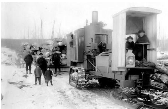
Рис. 29. Паровые полугусеничные снегоходы начала XX в.
