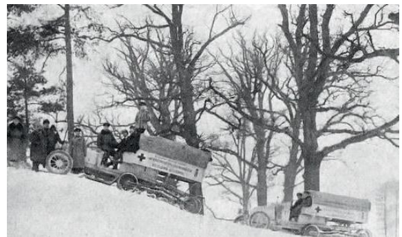
Рис. 50. Автосани Renault и «Руссо-Балт» из состава санитарной колонны ИРАО. Фотографии из репортажа в журнале «Автомобиль» № 4 за 1917 г
