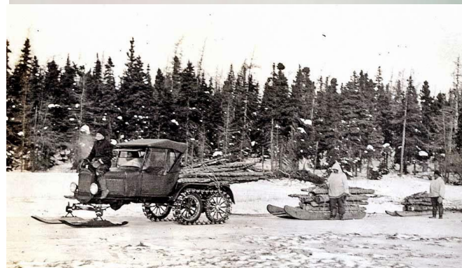
Рис. 64. Полугусеничный Форд Т (версии Snowmobile)
