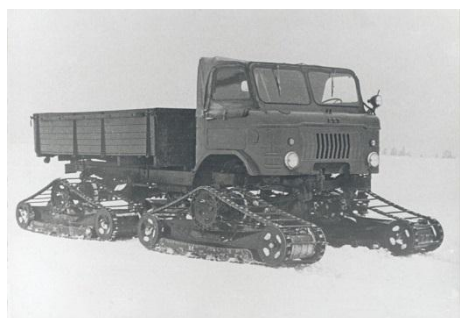
Рис. 68. Автомобили ГАЗ-66 и ГАЗ-69 с модульно-гусеничным двигателем (1960-1961 гг.)
