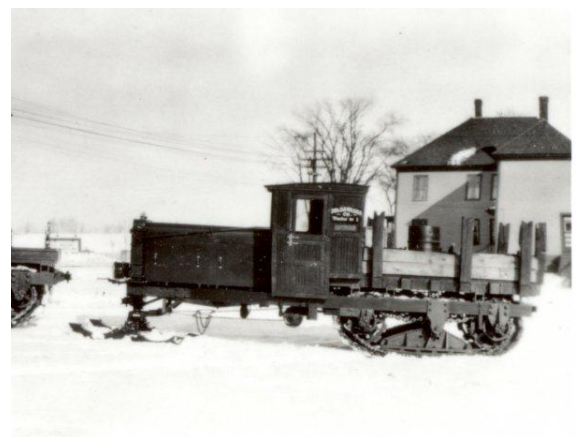
Рис. 30. Аналогичные полугусеничные снегоходы начала XX в. с паровой машиной и двигателем внутреннего сгорания
