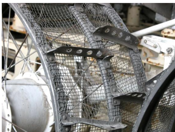
Рис. 8. Колесо лунохода (1970 г.)
