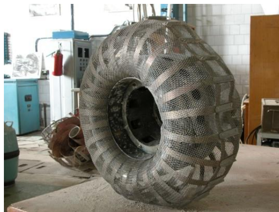
Рис. 9. Колесо для лунохода из упругой сетки (1970 г.)
