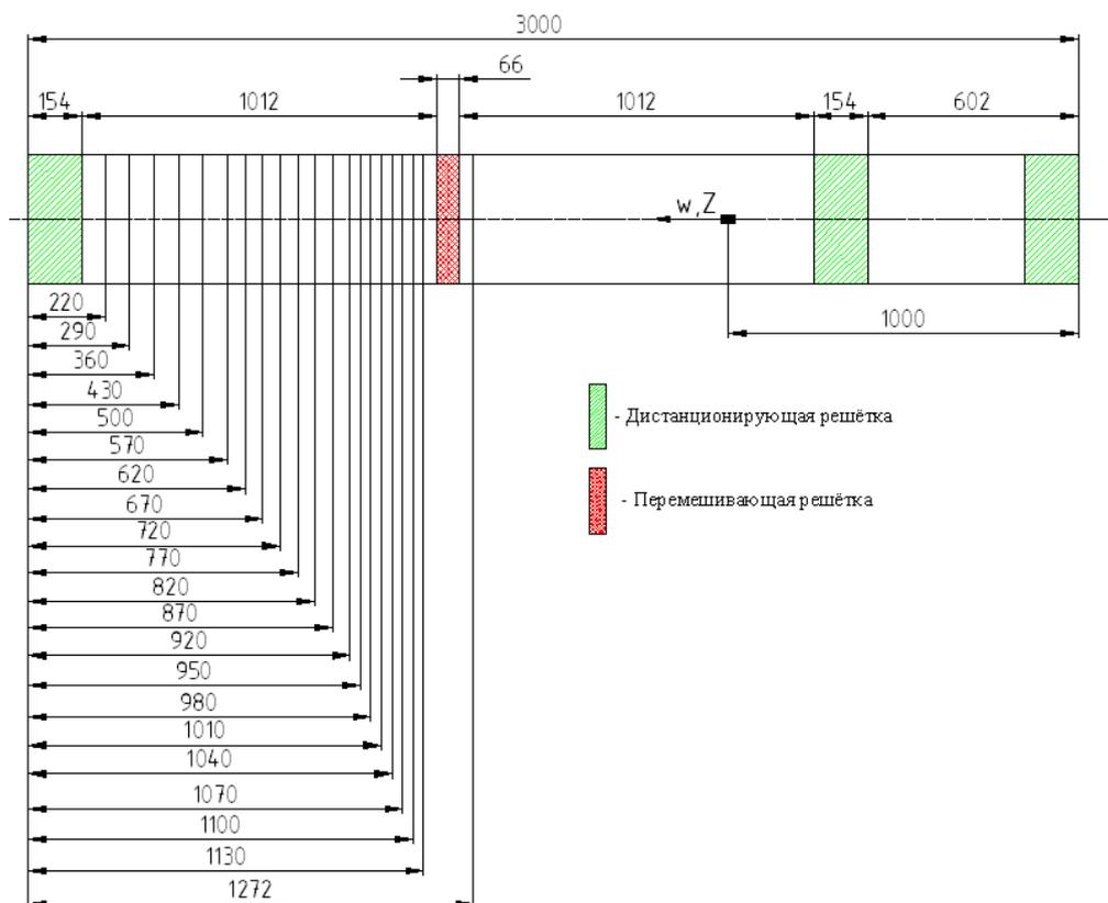
Рис. 5. Сечения измерения концентрации трассера по длине ЭМ
