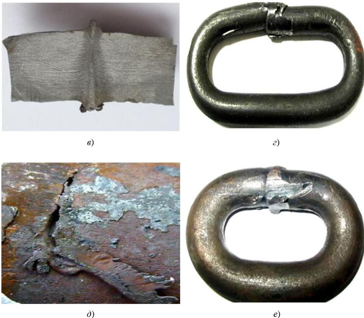
**Рис. 2 (окончание). Визуальное изображение дефектов сварного соединения:**
