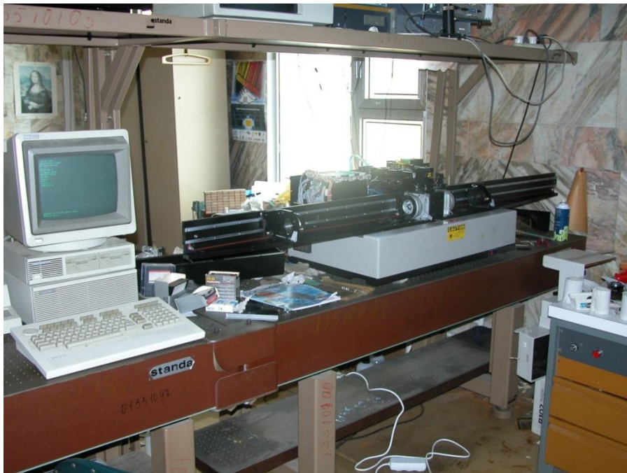
Рис. 1. Внешний вид анализатора заготовок P-102 фирмы York Technology для измерения профиля показателя преломления кварцевых заготовок
