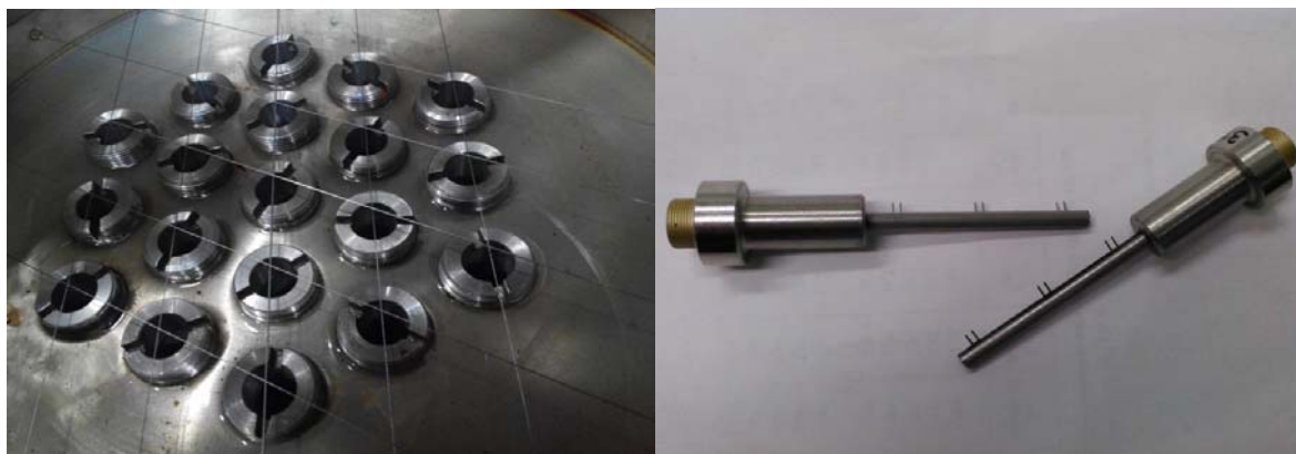
Рис. 2. Исследовательская часть измерительной системы: а – сетчатый датчик (верхняя камера); б – стержневые датчики
