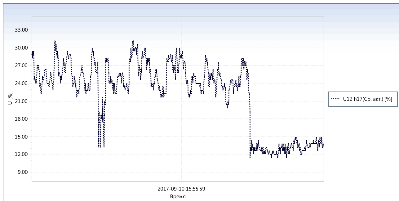
Рис. 6. График изменения семнадцатой гармонической составляющей напряжения
