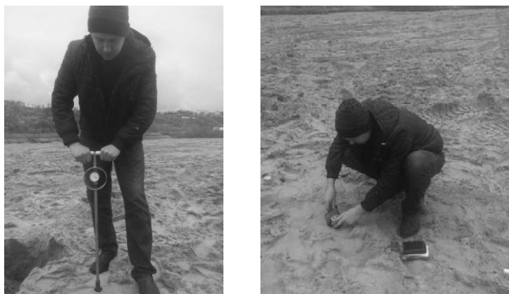
Рис. 3. Фрагмент замеров физико-механических свойств грунта
