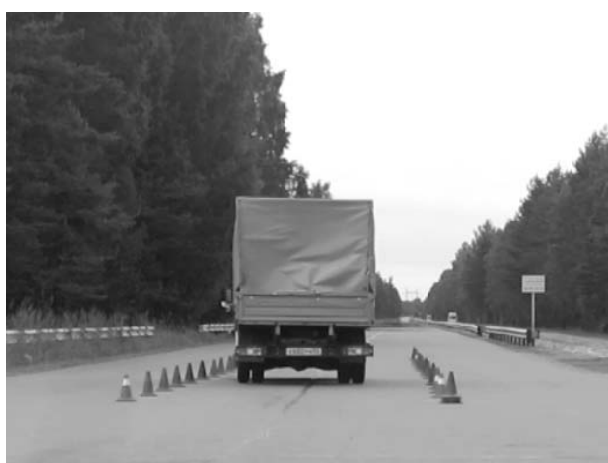
Рис. 2. Фрагменты проведения испытания «переставка 20м» в различных условиях: а – на сухом покрытии; б – на сыром покрытии
