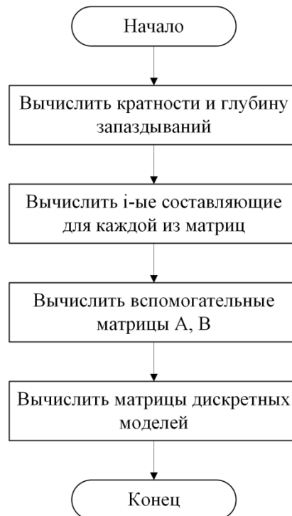
Рис. 1. Блок-схема алгоритма дискретизации стационарных и нестационарных моделей
