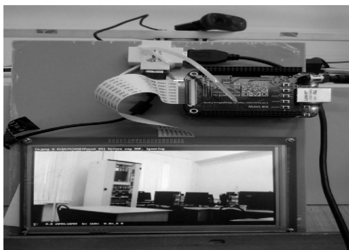
Рис. 3. Пример реализации системы «Интеллектуальные прозрачные стойки» с ОК Beagle Bone Black
