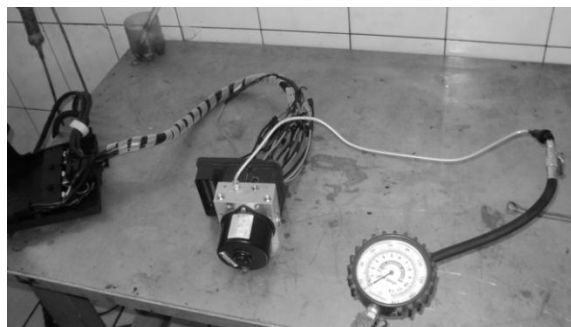
Рис. 6. Подключение к соленоидам блока ABS
