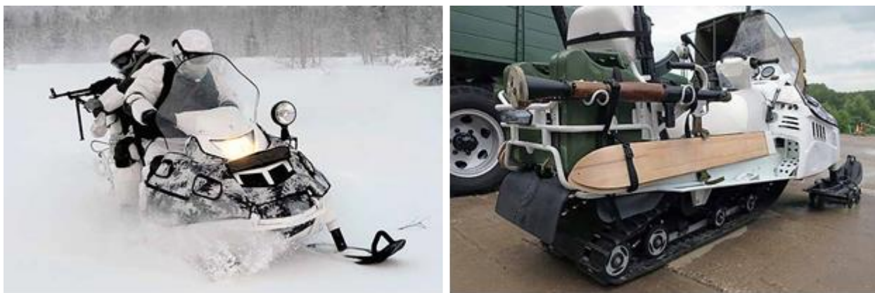
Рис. 5. Армейский снегоход АС-1 на базе модели «Тайга Патруль 551 СВТ»
