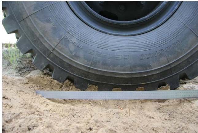
Рис. 5. Измерение параметров взаимодействия колесного движителя с грунтом
