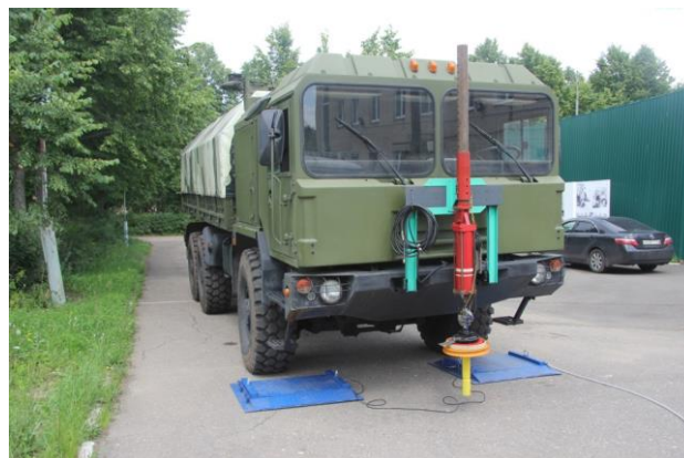
Рис. 2. Используемый тягач МЗКТ-6001 с установленным пенетрометром
