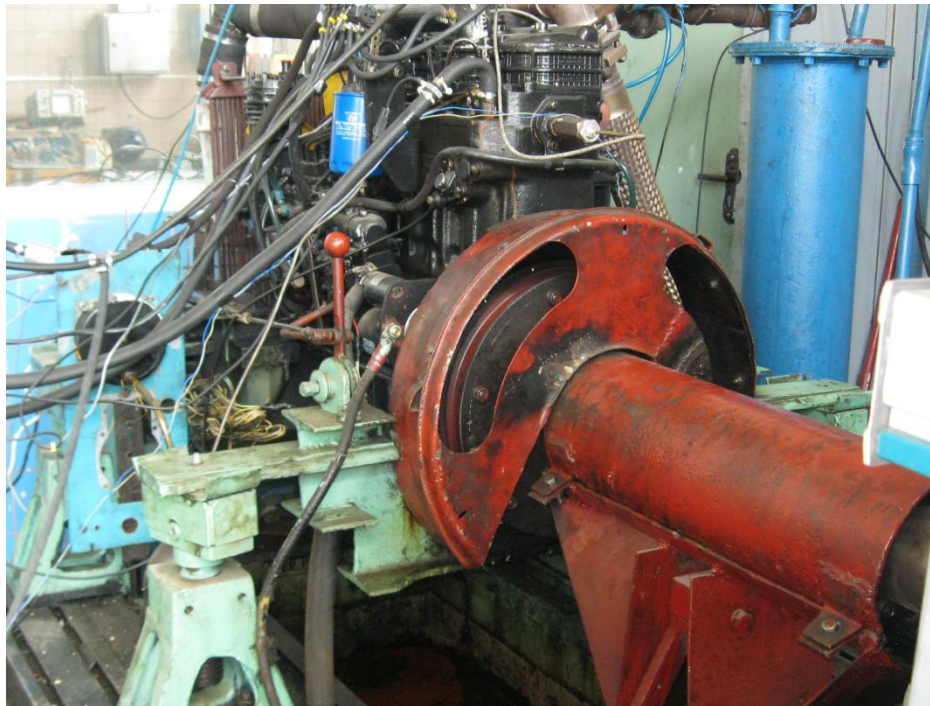
Рис. 3. Общий вид дизеля 4ЧН 11,0/12,5 (Д-245.5S5) с модернизированной системой питания
