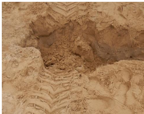
Рис. 4. Песчаный ров после проезда ТС «Корсаж»
