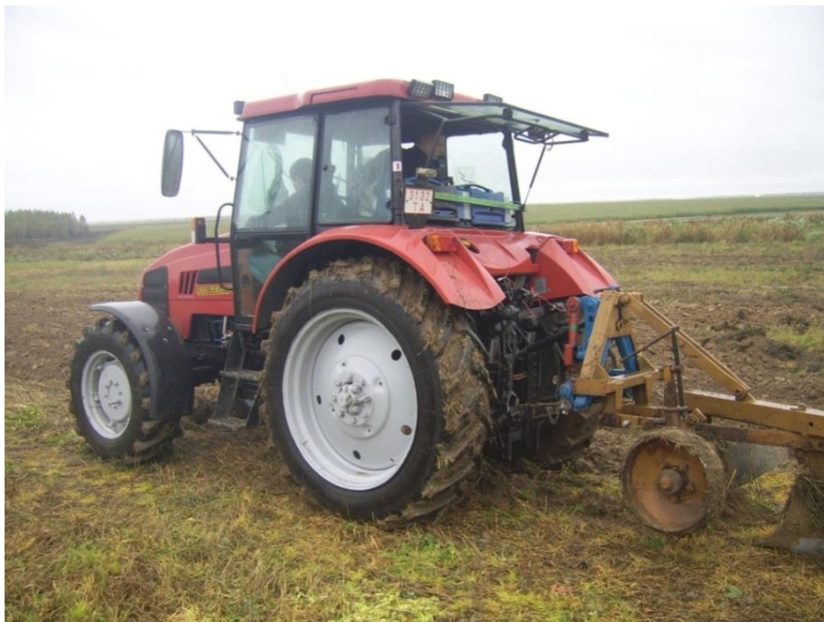
Рис. 3. Общий вид трактора Беларус-922 с плугом ПЛН-3-35 при полевых испытаниях
