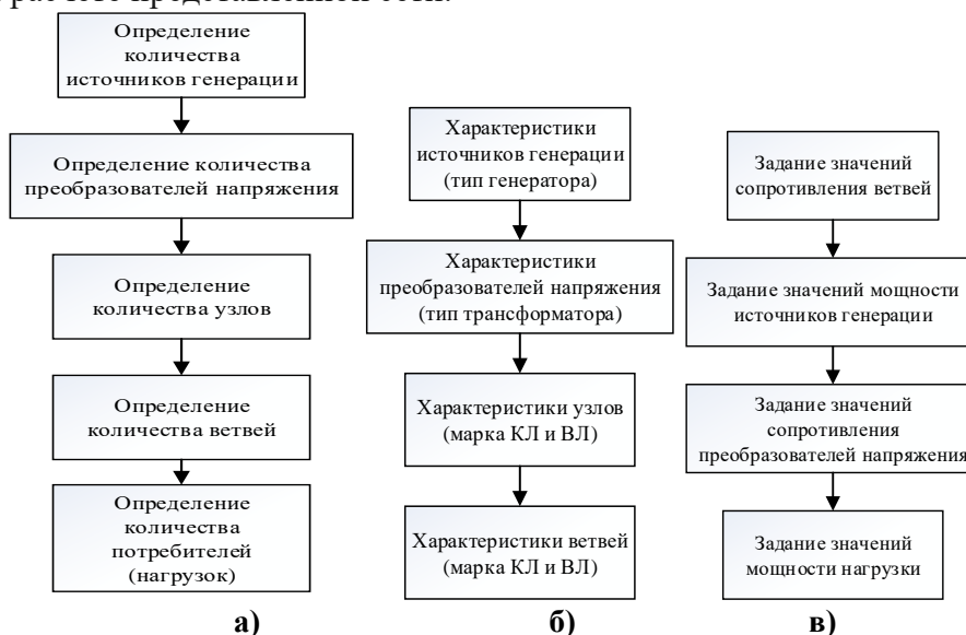
Рис. 6. Блок-схема алгоритма управления режимом сети
