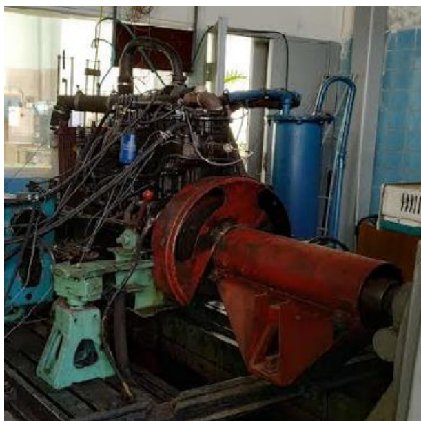
Рис. 2. Электротормозной нагрузочный стенд RAPIDO SAK N670 с балансирной маятниковой машиной
