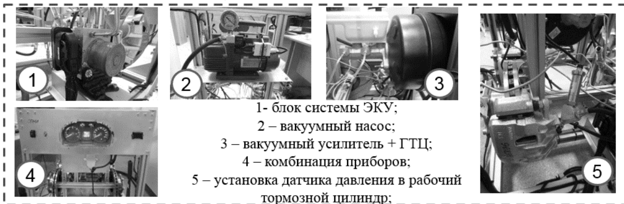
Рис. 2. Внешний вид разработанного стенда (ПАК)
