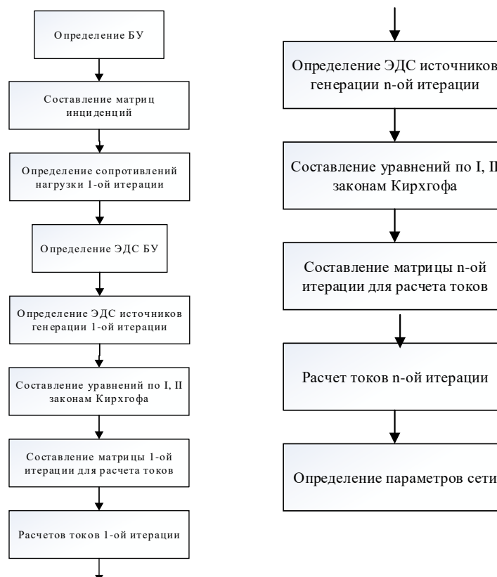
Рис. 7. Блок-схема алгоритма управления режимом сети – «Расчет режима сети»
