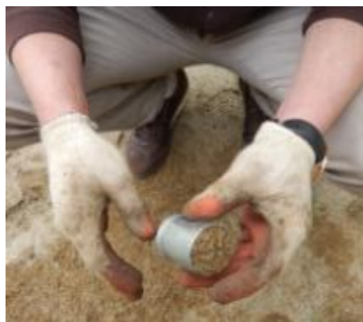
Рис. 9. Определение параметров песчаного опорного основания [21]
