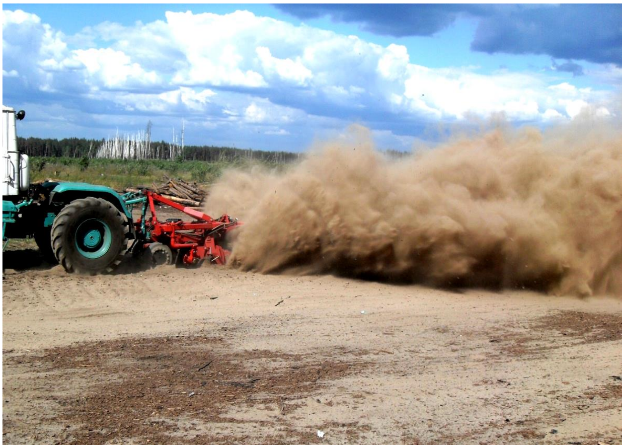
Рис. 1. Полевые испытания разработанного коллективом ученых ВГЛТУ грунтомета-полосопрокладывателя, агрегируемого с трактором Т-150К
