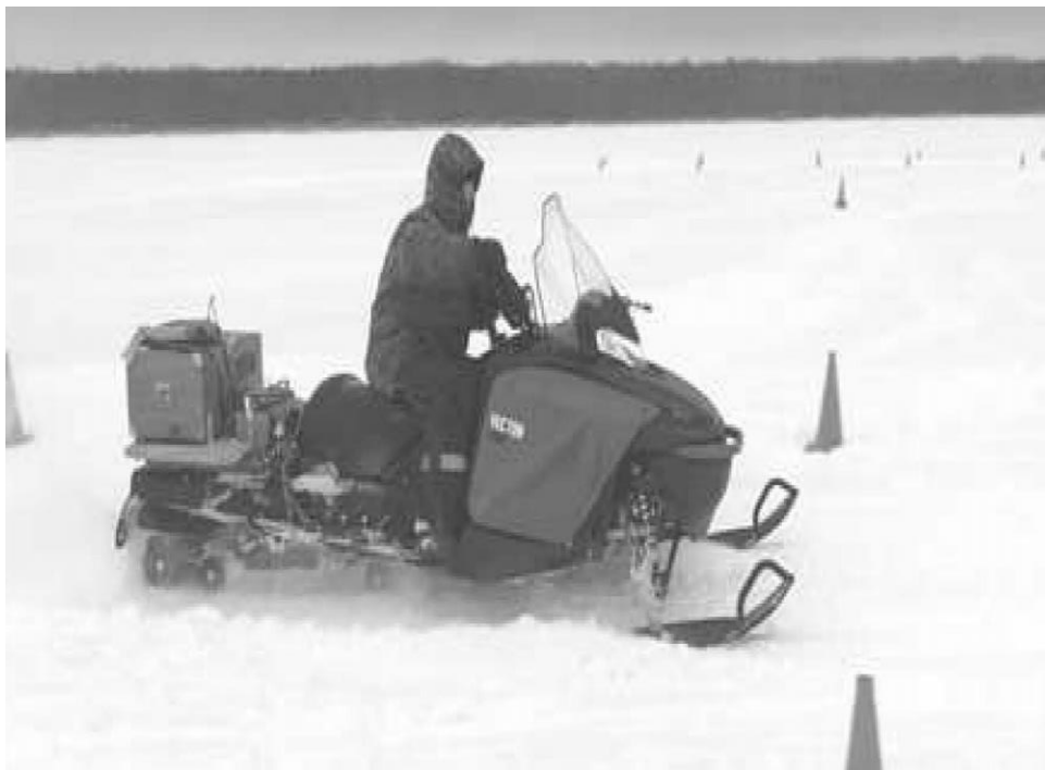
Рис. 9. Пример разработанной установки ИИС на снегоход РМ Vector 1000
