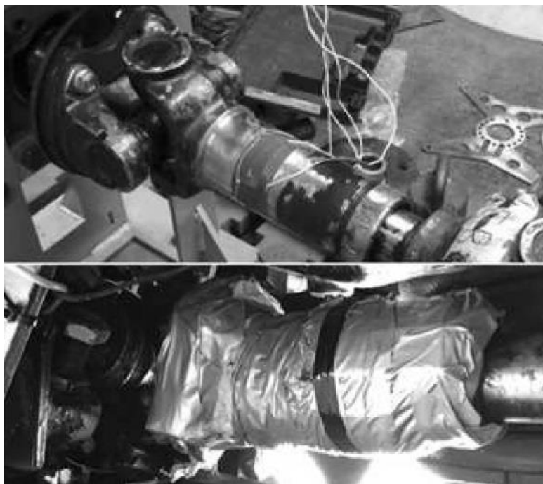
Рис. 7. Применение тензометрии на приводном валу
