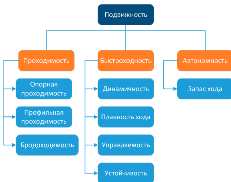
Рис. 3. Иерархия комплексного свойства подвижности
