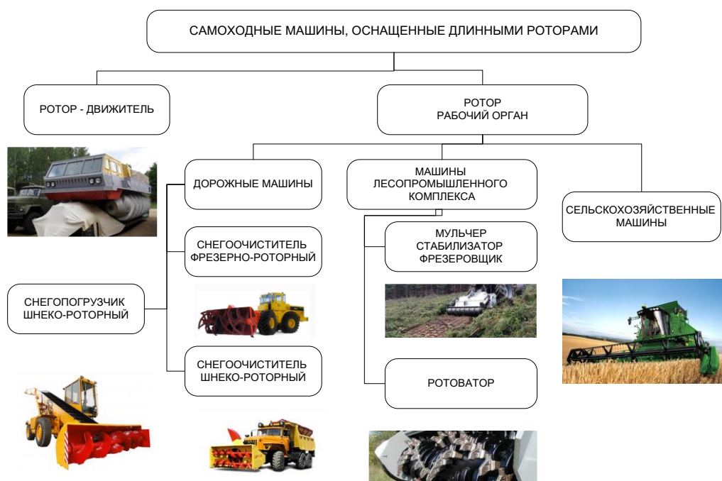
Рис. 1. Структуризация типов машин, оснащенных длинными винтовыми роторами
