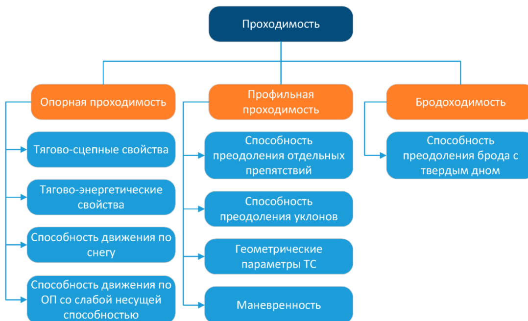
Рис. 4. Иерархия комплексного свойства проходимости
