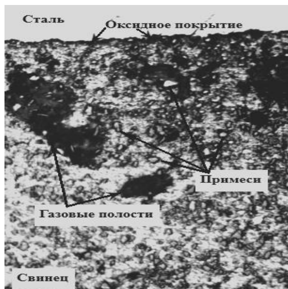
Рис. 4. Кольцевой зазор «свинец-втулка» при 200-кратном увеличении ( T=450^{\circ}\text{C} , t=50 ч, a=10^{-1}\text{-}10^0 , \gamma=700 об/мин)
