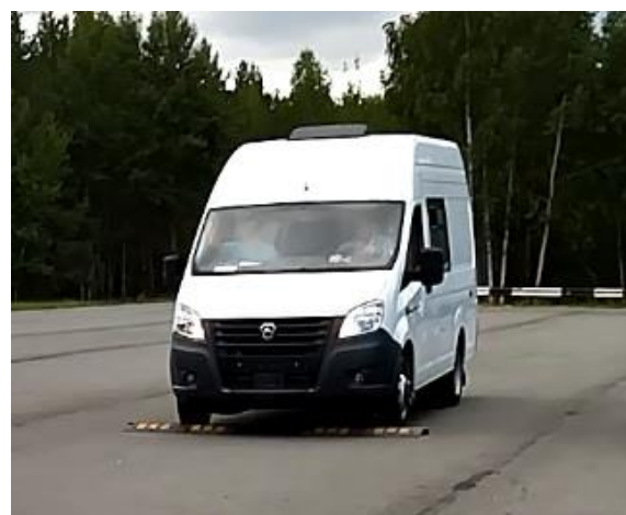
Рис. 11. Фрагмент испытаний подвески при переезде единичной неровности
