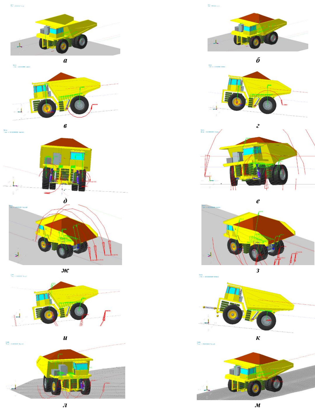
Рис. 8. Иллюстрации примеров моделирования нагрузочных режимов: a – статика без груза; б – статика с грузом; в – переезд рампы 10 % с грузом – движение на спуске; г – переезд рампы 10 % с грузом – движение на подъеме; д – косогор 5 %; е – криволинейное движение; ж – разгон; з – торможение; и – торможение на спуске; к – буксировка вперед без груза на подъеме; л – спуск с поворотом вперед; м – движение по неровной опорной поверхности
