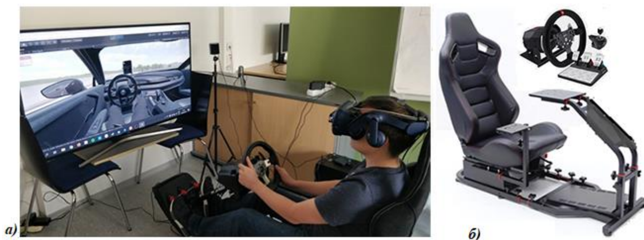
Рис. 6. Общий вид имитационного стенда с смешанной реальностью (а), имеющиеся конструкции стенда на aliexpress.com (б)
