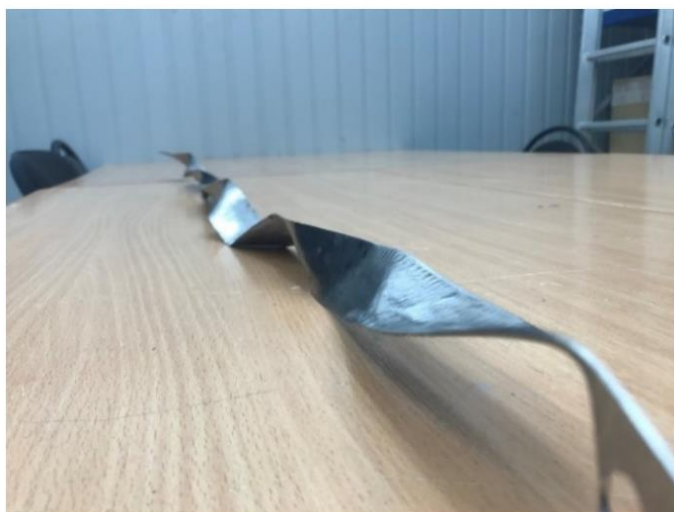
Рис. 2. Ленточный завихритель экспериментальной модели
