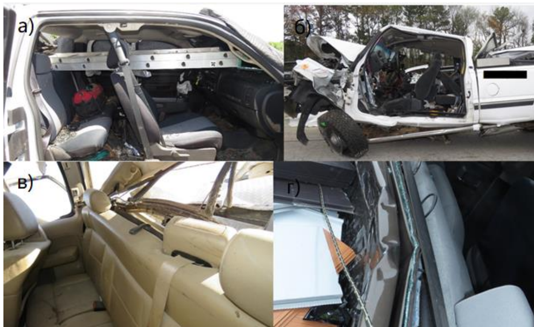
Рис. 1. Примеры ДТП пикапов, связанных со смещением грузов: а) Chevrolet Silverado 1500; б) Chevrolet Silverado 2500; в) Ford F-150; г) GMC Sierra 1500
