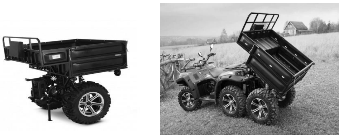
Рис. 1 Демонтируемый модуль грузовой платформы
