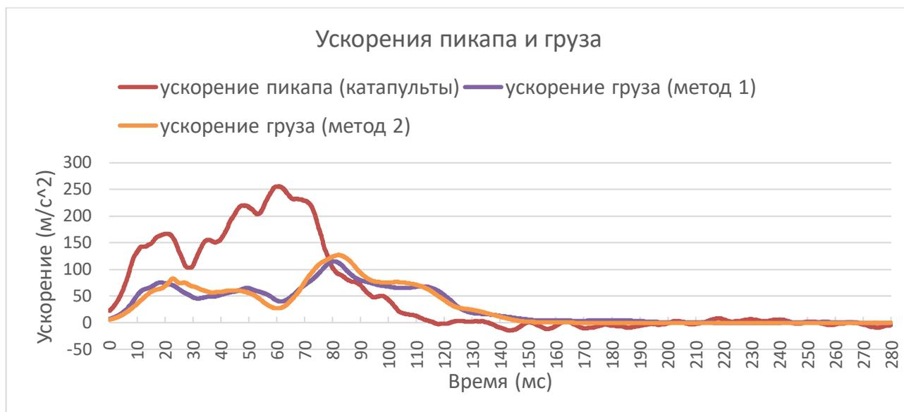
Рис. 9. Ускорение автомобиля и груза
