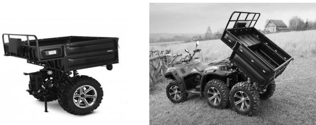
**Рис. 1** Демонтируемый модуль грузовой платформы
