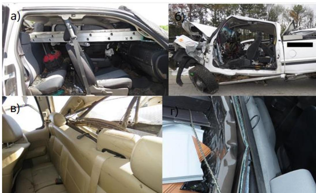
**Рис. 1. Примеры ДТП пикапов, связанных со смещением грузов:**
