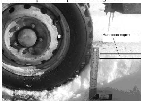
Рис. 2. Шурф при качении колеса по снегу с настовой коркой
