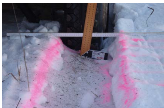
Рис. 1. Экскавация при криволинейном движении эластичного движителя
