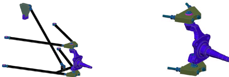
Рис. 1. 3-D схема передней подвески болида Formula Student
