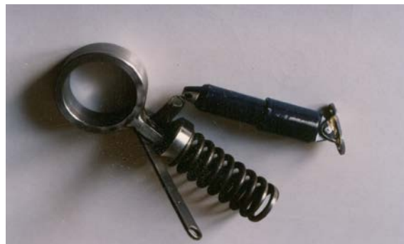
Рис. 1. Фотографии экспериментальной масштабной модели роторно-винтовой машины с установленным датчиком виброперемещений и элементов упруго-вязкой подвески роторов машины
