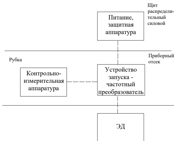
Рис. 1. Привод электровентилятора каверны
