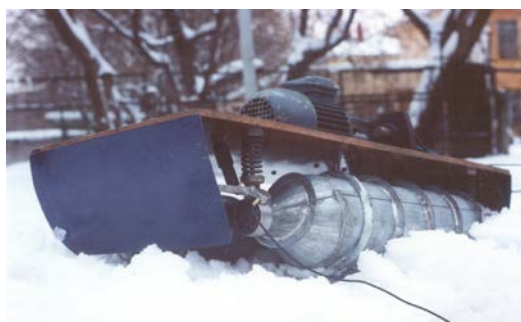
Рис. 1. Фотографии экспериментальной масштабной модели роторно-винтовой машины с установленным датчиком виброперемещений и элементов упруго-вязкой подвески роторов машины
