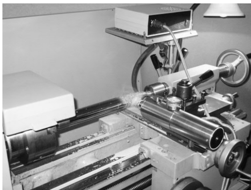
Рис. 1 Обработка детали на ультразвуковом станке
