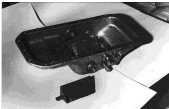
Рис. 1. Поддон картера двигателя ЗМЗ-511.10 (экспериментальный)
