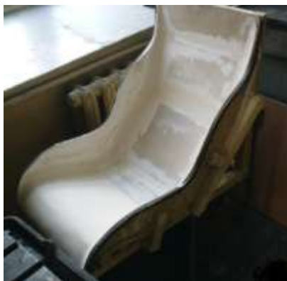
Рис. 2 Матрица для изготовления сидения
