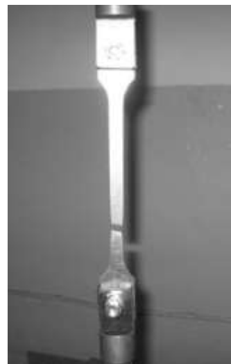
Рис. 2. Образец после испытания на разрывной машине
