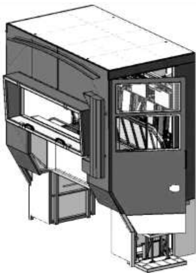
Рис. 1. Кабина боевого расчета ПА
