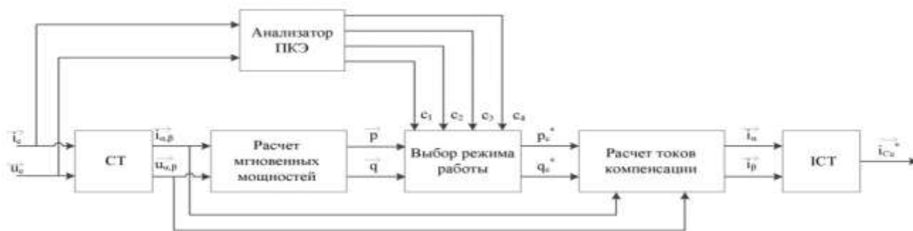
Рис. 2. Структурная схема (алгоритм) расчета компенсационного тока, основанная на р-q теории мгновенной мощности
