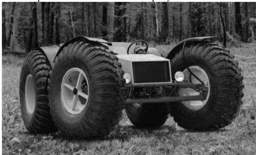
Рис.6. Наиболее рациональная компоновка вездеходного транспортного средства, предназначенного для доставки людей и грузов в условиях Северного Кавказа
