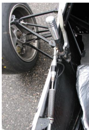
Рис.1. Гидравлическая система переключения скоростей
