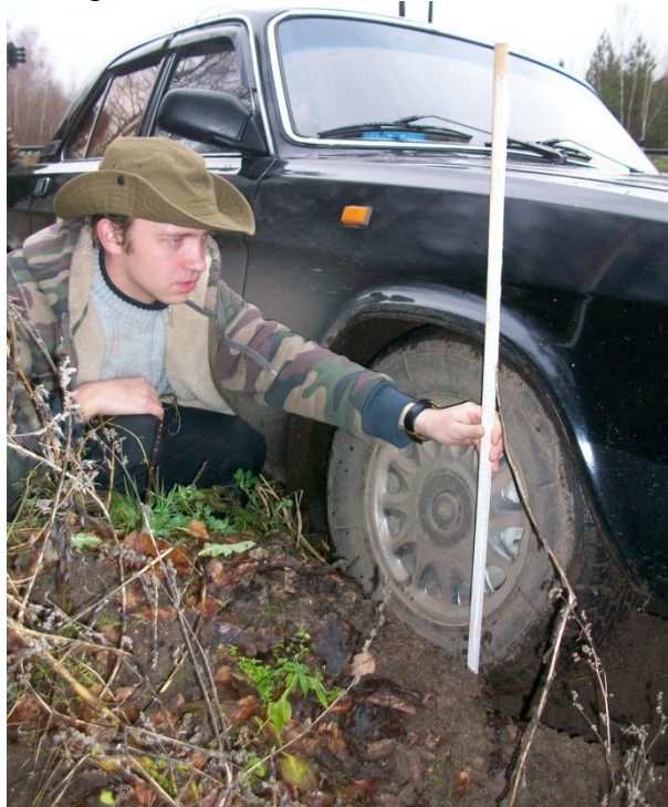
Рис. 1. Замер параметров разрушаемого препятствия после проезда автомобиля (в данном случае машина застряла)
