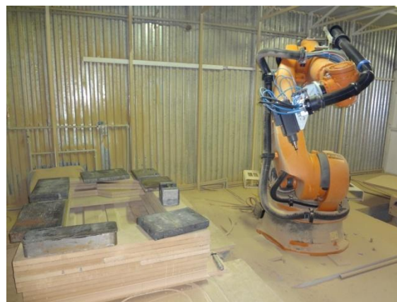
Рис. 2. Обработка заготовки оснастки для создания аэродинамического обвеса
