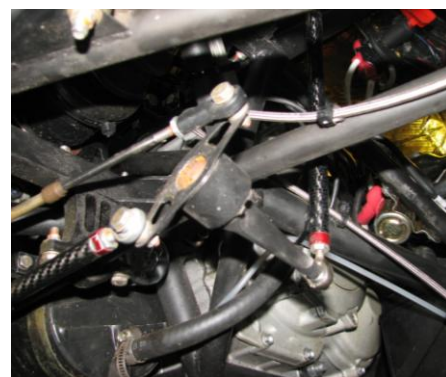
Рис.2. Механическая тросовая и рычажная система переключения скоростей
