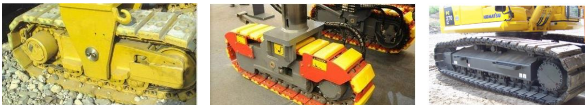
Рис. 1. Примеры использования полиуретановых гусеничных движителей в дорожно-строительной технике: дорожные фрезы и экскаваторы компаний Wirtgen, Bitelli, Komatsu
