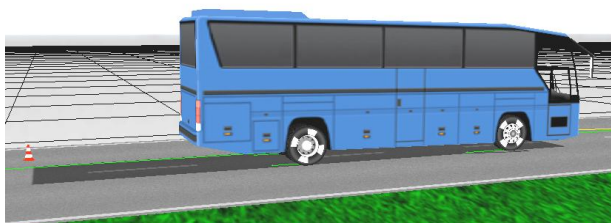
Рис. 1. Виртуальные испытания по оценке тормозных свойств модели автобуса
