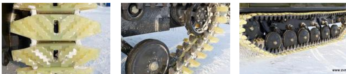
Рис. 2. Асфальтоходная мелкозвенчатая из армированного полиуретана с параллельным резинометаллическим шарниром (ООО «Завод вездеходных машин»)
