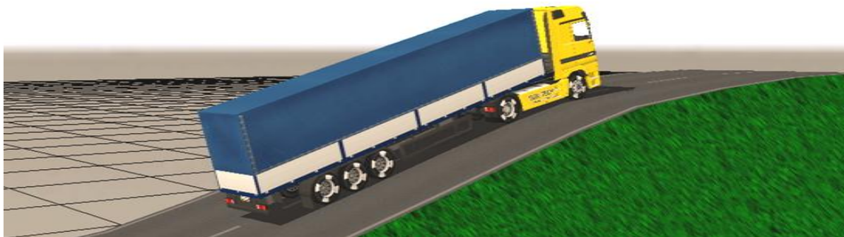
Рис. 1. Имитация движения автопоезда на подъеме в программе SDK-Simulation
