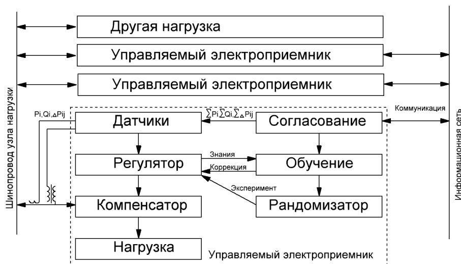
Рис.1. Структурная схема узла нагрузки с управляемыми электроприемниками
