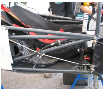
Рис.2. Механическая тросовая и рычажная система переключения скоростей
