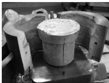
Рис. 1. Литая заготовка биметаллического пресс-поршня, полученная по предлагаемой технологии
