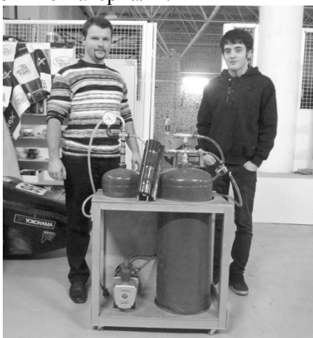
Рис. 1. Установка для вакуумной инфузии созданная участниками СКБ «Формула Студент»
