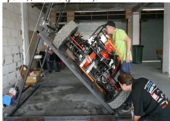
Рис. 1. Испытание на опрокидывание спортивного автомобиля класса «Formula Student»
