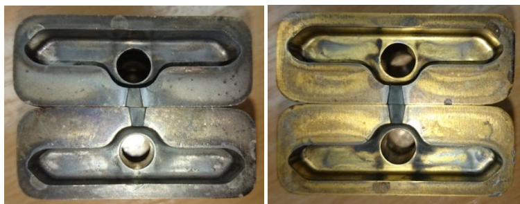
Рис. 1. Вкладыши пресс-формы после 30000 запрессовок:
