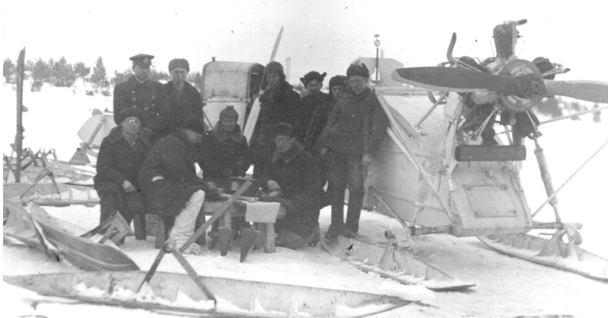
Испытательная группа Отдельного конструкторского бюро Наркомата Речного Флота (аэросани РФ-8 с автомобильным и авиационным двигателями)
