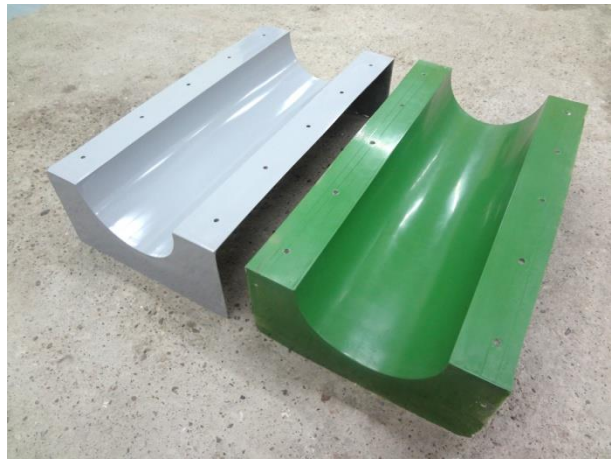
Рис. 4. Создание технологической оснастки для получения элементов несущих систем и компонентов с использованием технологий цифрового производства и быстрого прототипирования
