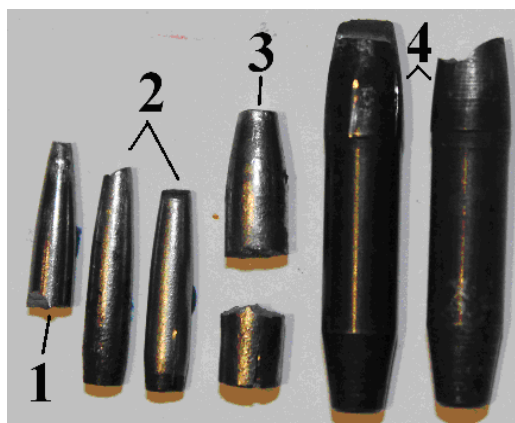
Рис. 1. Разрушение сердечников при испытании
