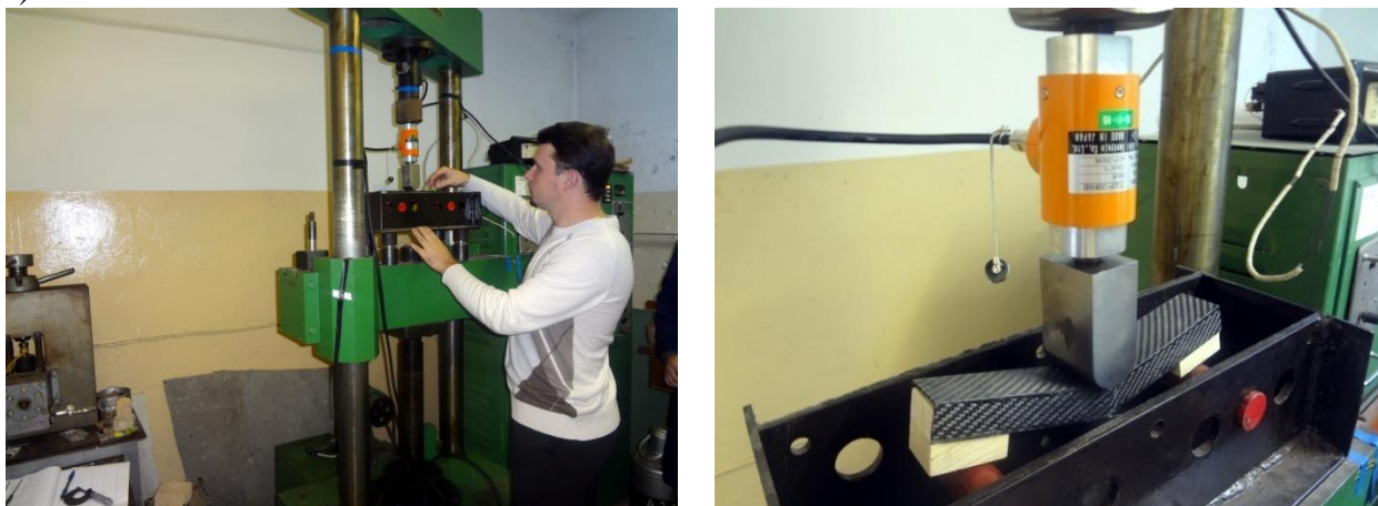
Рис. 1. Проведение исследований физико-механических свойств композиционных материалов
