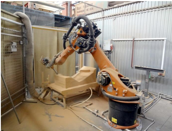
Рис. 4. Создание технологической оснастки для получения элементов несущих систем и компонентов с использованием технологий цифрового производства и быстрого прототипирования
