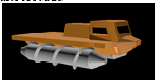
Рис. 1. 3D модель роторно-винтовой машины и ее упруго-вязкой опоры
