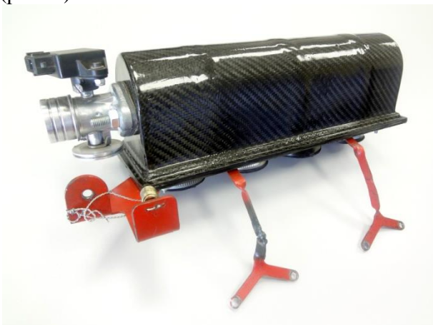
Рис. 5. Создание компонентов спортивных автомобилей класса Formula Student на основе композиционных материалов (элементы впускной и выхлопной системы)
