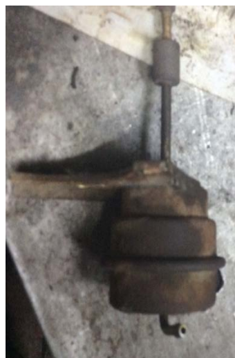
Рис. 2. Актуатор (вакуумный привод перепускного клапана)
