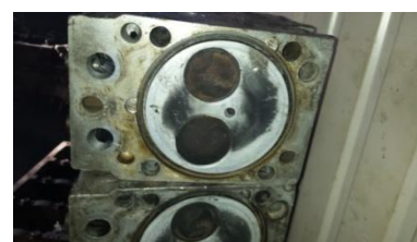
Рис.3. Прогар клапанов ГБЦ
