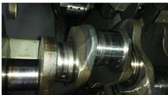
Рис. 1 Задиры на коренных и шатунных шейках коленчатого вала.
