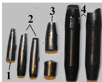
Рис. 2. Разрушение сердечников при испытании
