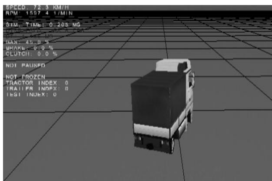
Рис. 1. Виртуальное испытание ЛКА на маневр по усеченной синусоиде
