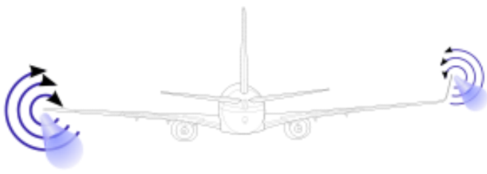
Рис. 1. Индуктивные вихри на крыле
