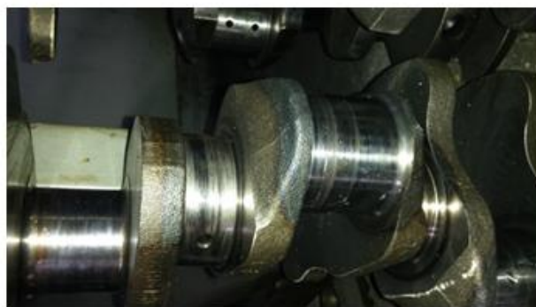
Рис.3 Задиры коренных и шатунных шеек коленчатого вала.
