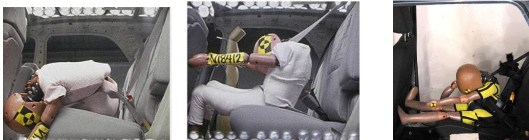
Рис. 3 Испытания двух-, трех- и четырехточечных ремней безопасности при перевозке детей
