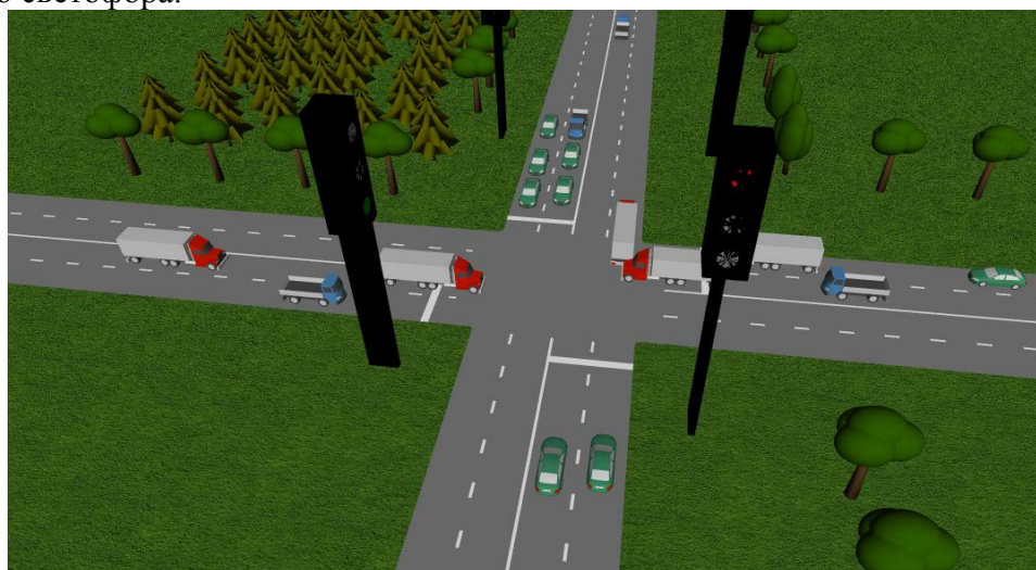
Рис. 1. Имитационная модель адаптивного светофора в Anylogic
