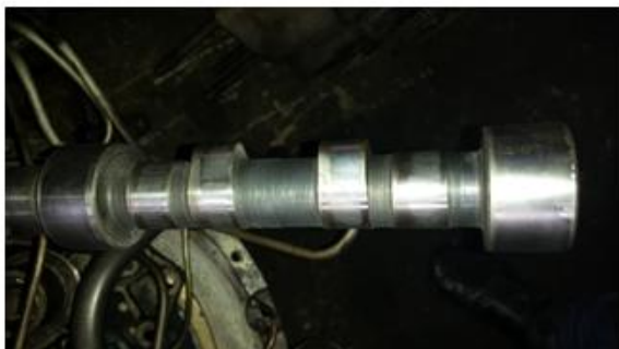
Рис.1 Износ кулачков распределительного вала. Рис.2 Сальник коленчатого вала.
