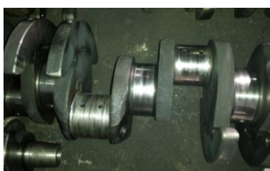
Рис.2. Задиры на коренных шейках коленчатого вала
