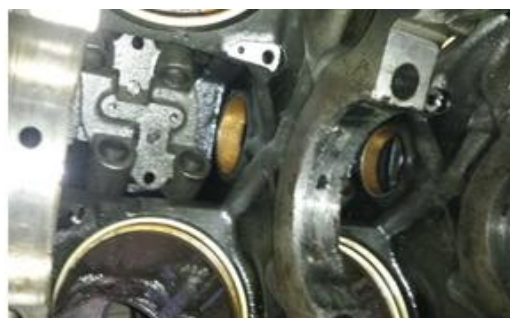
Рис.2 Трещина в блоке цилиндров.
