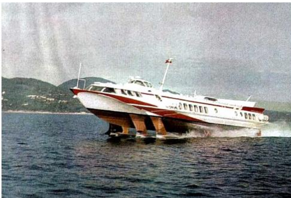
Первое в мире судно на подводных крыльях «Ракета»
