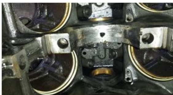
Рис.3 Износ постели блока цилиндров.
