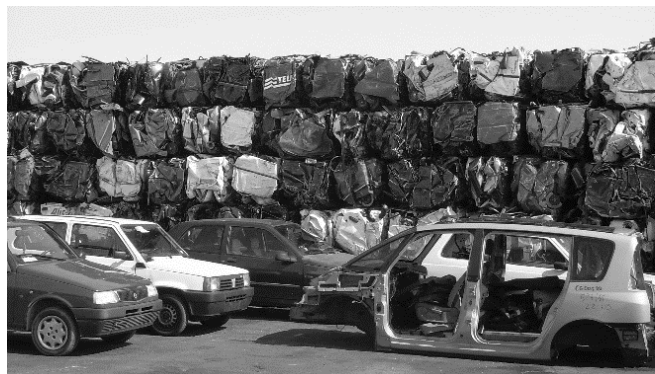
Рис. 1. Брикетирование вторичной продукции
