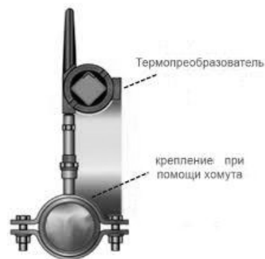
Рис. 1. Конструкция поверхностного измерителя температуры
