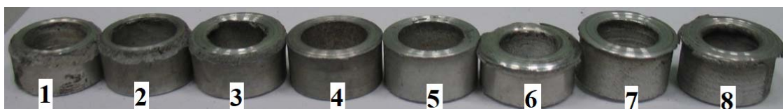
Рис. 3. Образцы после испытания по схеме «цилиндр-тормозная колодка»
