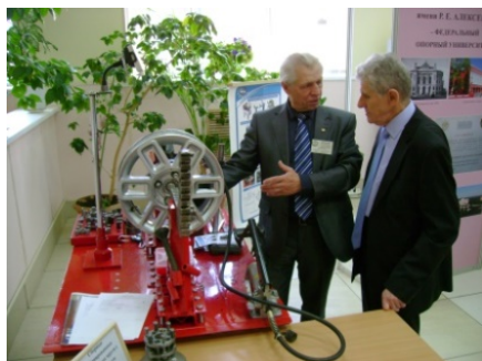
Рис. 1. Стенд для правки дисков на выставке в НГТУ
