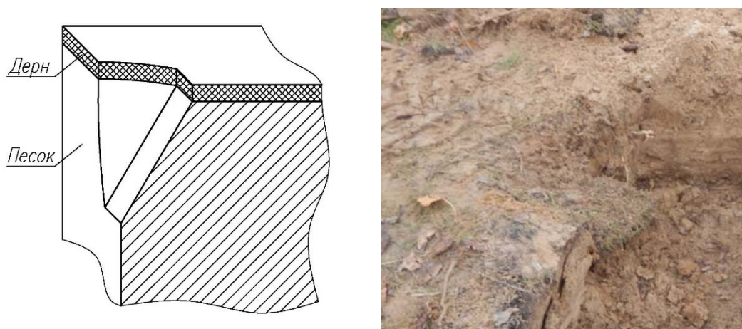
Рис. 1. Схема обрушение стенки реального рва на неоднородном грунте
