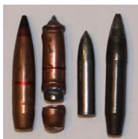
Рис. 1. Пуля Б-32 и сердечники пуль
