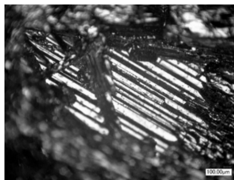
Рис. 2. Пример разрушения образца с размером включений более 1 мм
