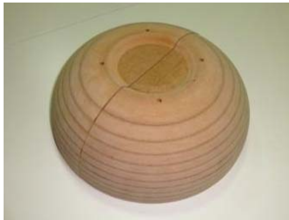
Рис. 2. Модельная оснастка верхней секции вакуумного ресивера
