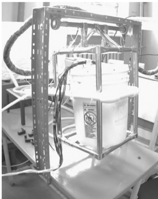
Рис. 1. Стенд по изучению воздействия качки на смешение неизотермических потоков (фото)
