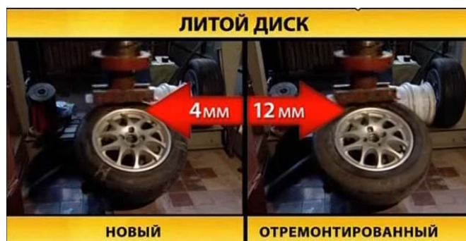
Рис. 1. Максимальные остаточные пластические деформации диска (нового и отремонтированного) при испытаниях по п.4.6 ГОСТ Р 50511-93
