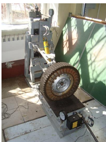
Рис. 1 – Статическое нагружение безвоздушной шины на стенде
