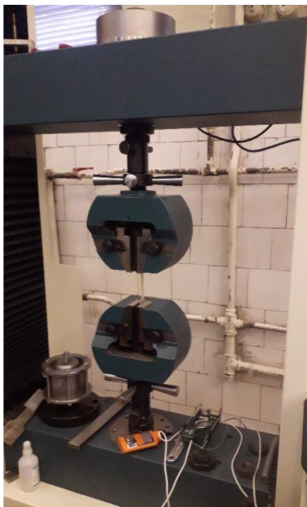
Рис. 1 – Испытательный образец, закрепленный на разрывном стенде
