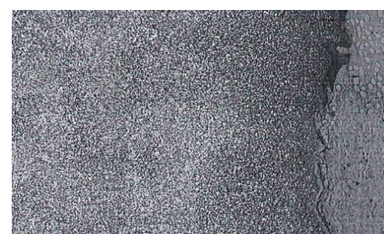
Рис.3 Травленая поверхность трещины
