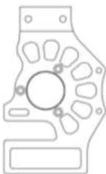
Рис.1. Эскиз поворотного кулака
