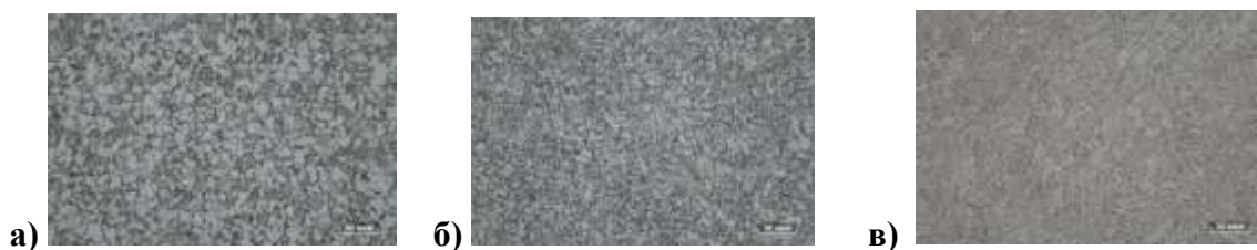
Рис. 4. Микроструктура материала класса прочности К – 52 после отпуска 500 °С при закалке: а) 900 °С, б) 950 °С, в) 980 °С
