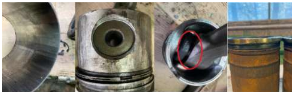
Рис.2 Задиры на поверхности гильзы цилиндра, задиры на поршне, срыв втулки шатуна, сгоревшие уплотнительные кольца гильзы цилиндра ЯМЗ 651.10
