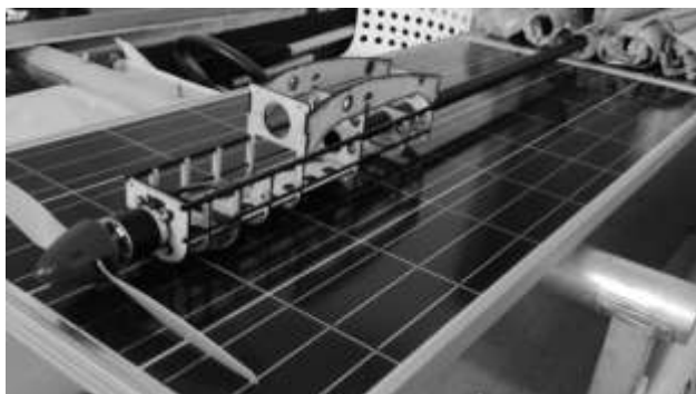
Рис.1. Изготовленный фюзеляж самолёта
