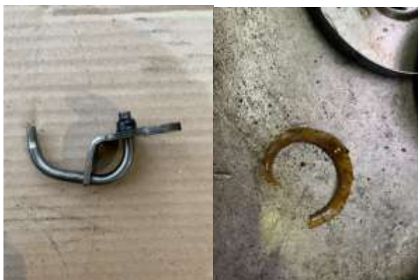
Рис. 3. Форсунка охлаждения поршня (слева). Посторонний предмет, затруднявший прокачку масла через форсунку (справа)
