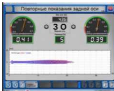
Рис.3. Диагностика задней оси на амортизационном стенде и результаты измерений исправных амортизаторов.
