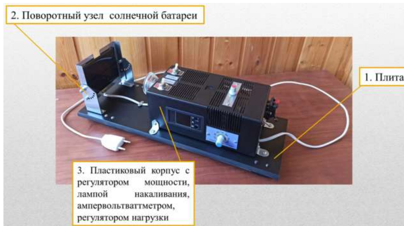
Рис.1. Установка для изучения работы солнечной батареи
