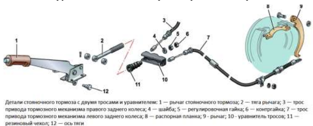
Рис. 1 Конструкция стояночного тормоза
