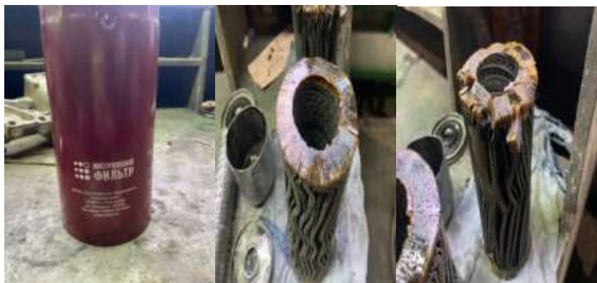
Рис.4. Фильтр грубой очистки масла производства ООО «Костромское предприятие «Автофильтр». Состояние внутренней части фильтрующего элемента
