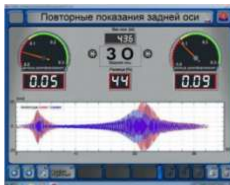
Рис.4. Результаты измерений. Неисправные амортизаторы.
