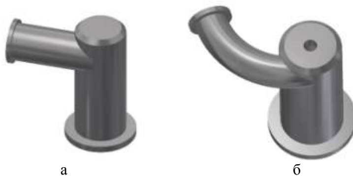
Рис. 1. Переходные элементы двухступенчатого гидроциклона а – по традиционной технологии, б – по аддитивной технологии
