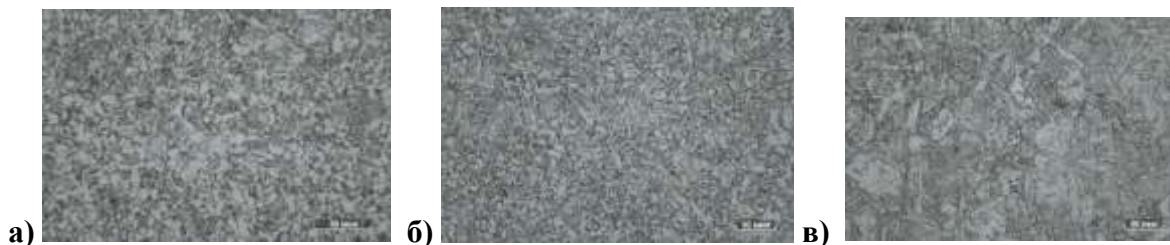
Рис. 3 Микроструктура материала класса прочности К – 52 после отпуска 300 °С при закалке: а) 900 °С, б) 950 °С, в) 980 °С
