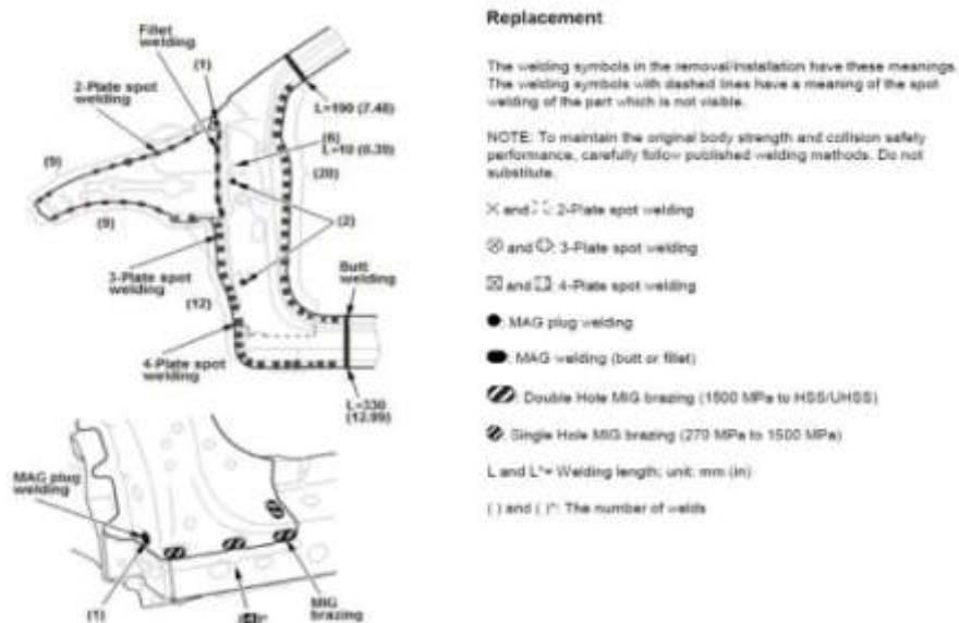
Рисунок 3. Рекомендации OEM Honda по ремонту передней стойки и полки переднего крыла
