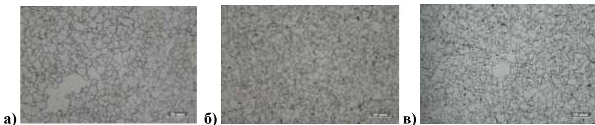
Рис. 6. Микроструктура стали класса прочности К – 52 после отпуска 800 °С при закалке: а) 900 °С, б) 950 °С, в) 980 °С
