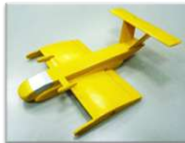
Рис. 1. Катапультная модель экраноплана (1:96)
