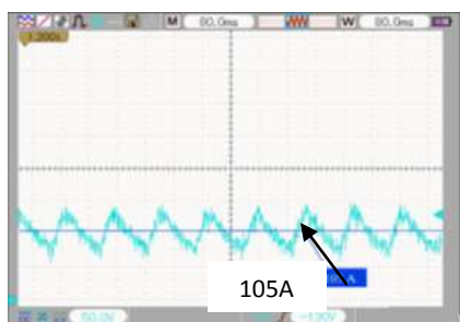
Рис. 5. Осциллограммы результатов диагностической операции (исправный двигатель)
