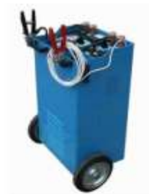
Рис. 3. Установка для зарядки АКБ
