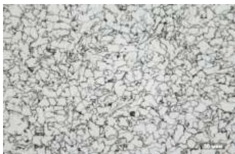
Рис. 1. Микроструктура материала класса прочности К-52 до влияния термической обработки
