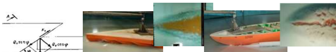
Рис. 3. Векторы воздействия сдвигом и сравнение испытаний моделей в ледовом бассейне КГНЦ
