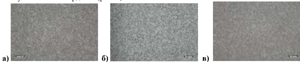
Рис. 5 Микроструктура материала класса прочности К – 52 после отпуска 680 °С при закалке: а) 900 °С, б) 950 °С, в) 980 °С
