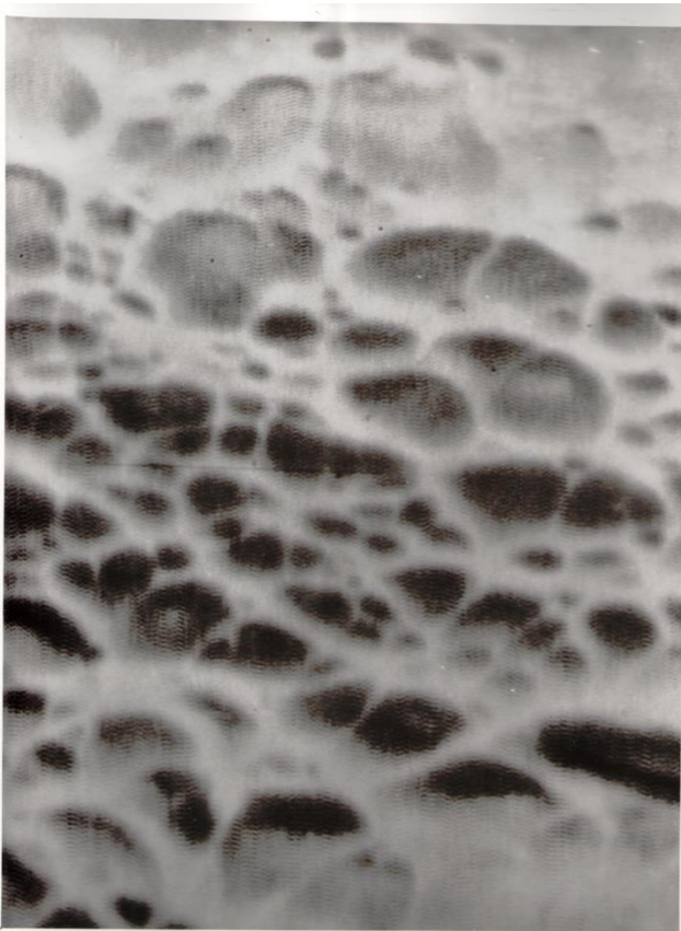
Рисунок 17 – Фото излома титанового сплава ОТ4-1, скорость деформации \dot{\epsilon} = 4,5 \cdot 10^{-2} \text{ c}^{-1} , двухосное растяжение, 500^{\circ}\text{C} ( \times 1400 )
