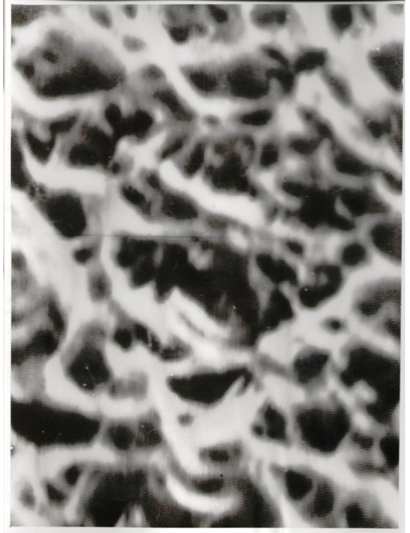
Рисунок 16 – Фото излома титанового сплава ОТ4-1, скорость деформации \dot{\epsilon} = 3,4 \cdot 10^{-3} \text{ c}^{-1} , двухосное растяжение, 600^{\circ}\text{C} ( \times 1400 )
