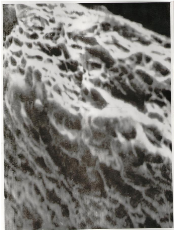
Рисунок 14 – Фото излома титанового сплава ОТ4-1, скорость деформации \dot{\epsilon} = 4,5 \cdot 10^{-2} \text{ c}^{-1} , одноосное растяжение, 800^{\circ}\text{C} ( \times 1400 )
