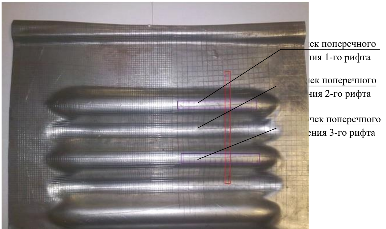
Рисунок 2.11 – Делительная сетка на гофрированной панели с указанием зон измерений
