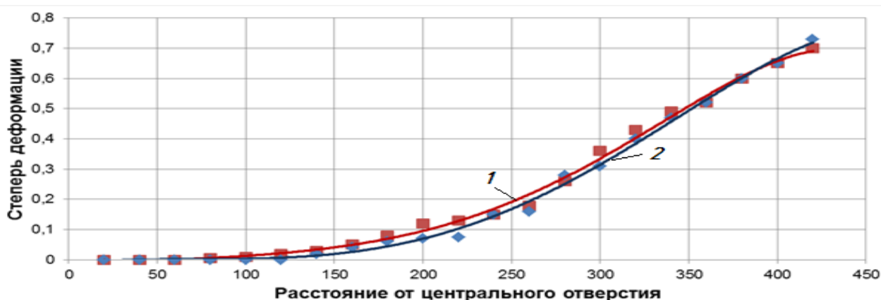
Рисунок 2.9 – Зависимость степени деформации (относительного удлинения \delta ) слоев раскатанной заготовки по ее длине: 1 – со стороны прокатки; 2 – со стороны неподвижной плиты
