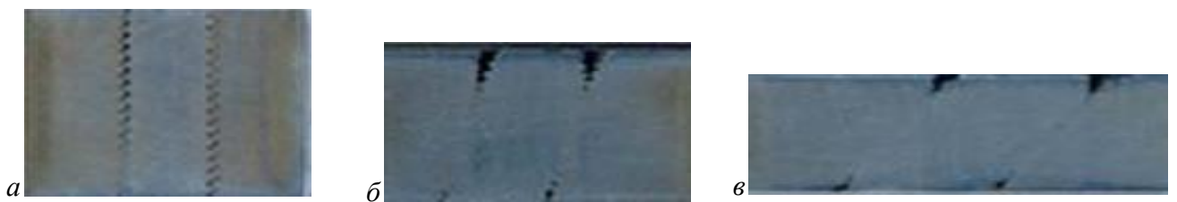
Рисунок 3 – Продольный профиль центральных винтов, установленных в заготовке и прокатанных со степенью деформации: а – 4%; б - 23%; в – 40%
