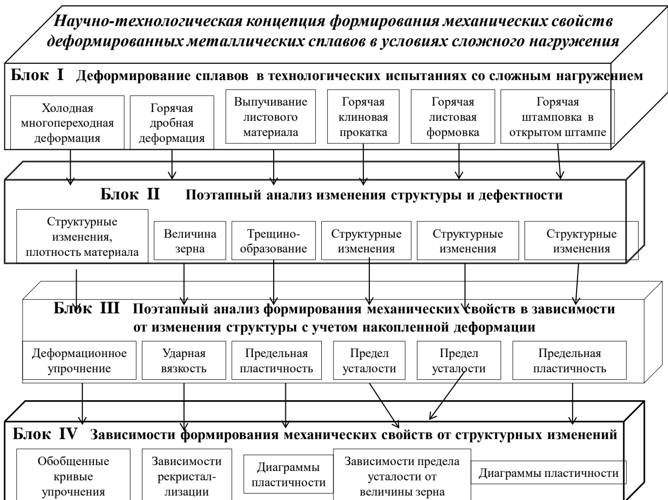
Рисунок 2.1 – Научно-технологическая концепция поэтапного формирования механических свойств деформированных металлических сплавов в условиях сложного нагружения
