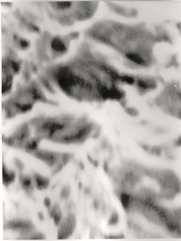
Рисунок 11 – Фото излома титанового сплава ОТ4-1, скорость деформации \dot{\epsilon} = 4,5 \cdot 10^{-2} \text{ c}^{-1} , одноосное растяжение, 20^{\circ}\text{C} ( \times 1400 )
