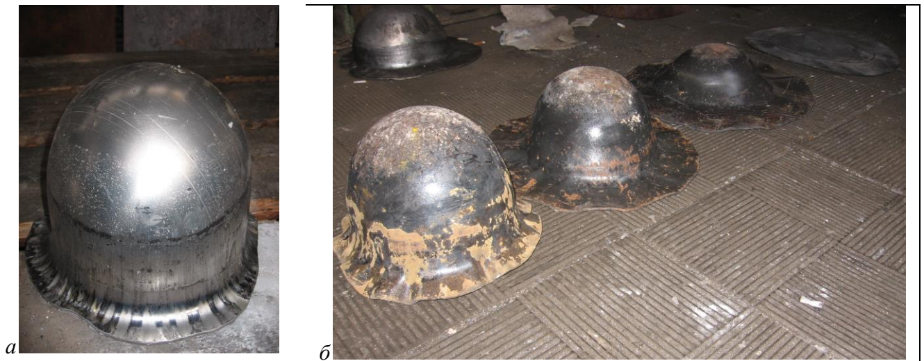
Рисунок 6.15 – Оболочка защитного шлема ( а ); фотографии переходов вытяжки ( б )
