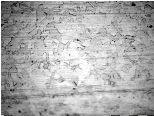
Рисунок 4.58 – Микроструктура стали 12X17Г9АН4 в состоянии поставки ( \times 340 )
