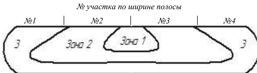
Рисунок 4.29 – Зоны поперечного сечения прокатанной полосы ( \epsilon_n = 4\% ) одинаковой твердости: 1 \approx 24...25 HRC; 2 \approx 25...26 HRC; 3 \approx 20...24 HRC
