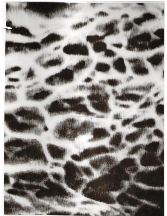
Рисунок 18 – Фото излома титанового сплава ОТ4-1, скорость деформации \dot{\epsilon} = 4,5 \cdot 10^{-2} \text{ c}^{-1} , двухосное растяжение, 700^{\circ}\text{C} ( \times 1400 )
