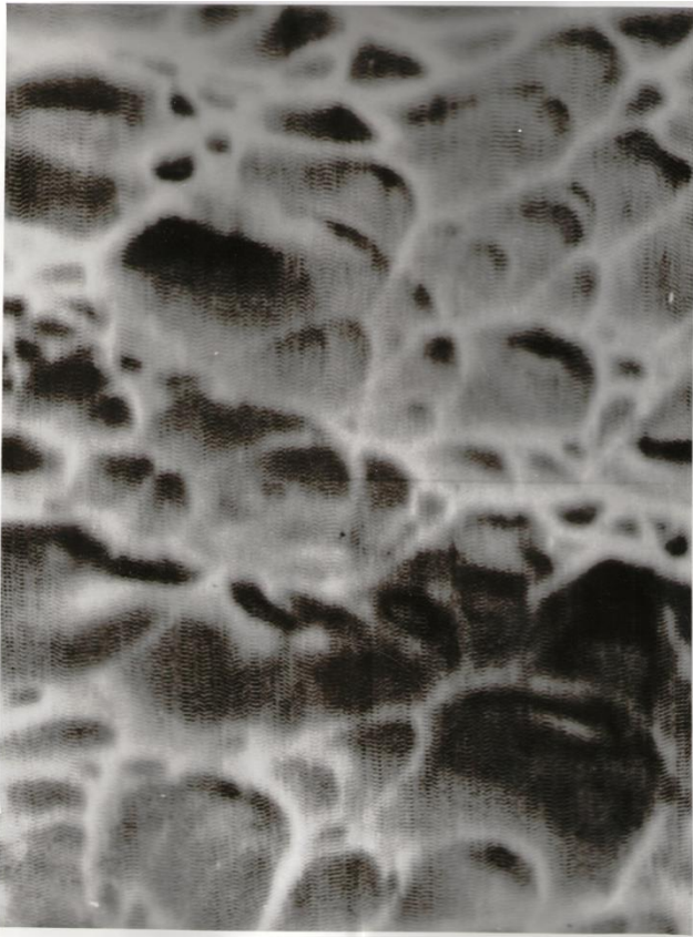
Рисунок 19 – Фото излома титанового сплава ОТ4-1, скорость деформации \dot{\epsilon} = 4,5 \cdot 10^{-2} \text{ c}^{-1} , двухосное растяжение, 600^{\circ}\text{C} ( \times 1400 )
