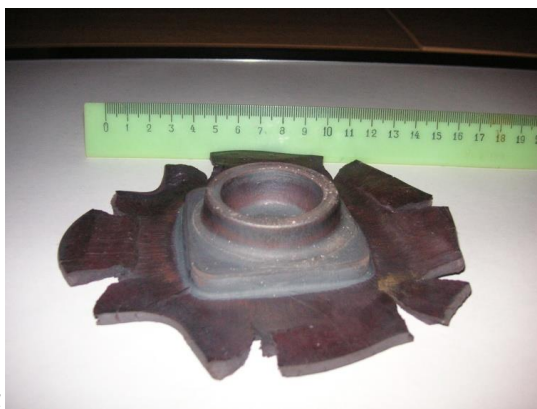
Рисунок 4.61 – Фотография поковки фланца ( а ) и схема резки ( б ) его четвертой части на слои для микроструктурного анализа
