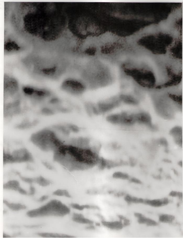
Рисунок 23 – Фото излома титанового сплава ВТ6С, скорость деформации \dot{\epsilon} = 4,5 \cdot 10^{-2} \text{ c}^{-1} , двухосное растяжение, 20^{\circ}\text{C} ( \times 1400 )
