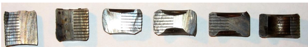
Рисунок 2.4 – Фотография ( а ) и схема резки заготовок переходов деформирования ( б ) из стали 10
