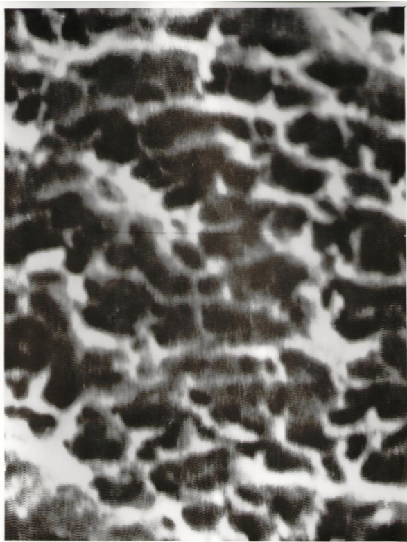
Рисунок 33 – Фото излома титанового сплава VT6S, скорость деформации \dot{\epsilon} = 3,8 \cdot 10^{-3} \text{ с}^{-1} , одноосное растяжение, 500^{\circ}\text{C} ( \times 1400 )
