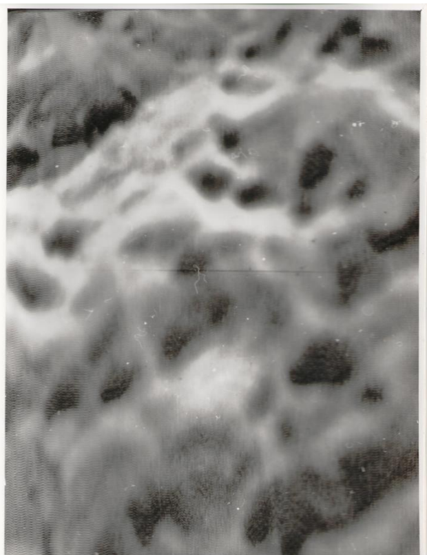
Рисунок 30 – Фото излома титанового сплава ВТ6С, скорость деформации \dot{\epsilon} = 3,1 \cdot 10^{-2} \text{ с}^{-1} , одноосное растяжение, 800^{\circ}\text{C} ( \times 1400 )
