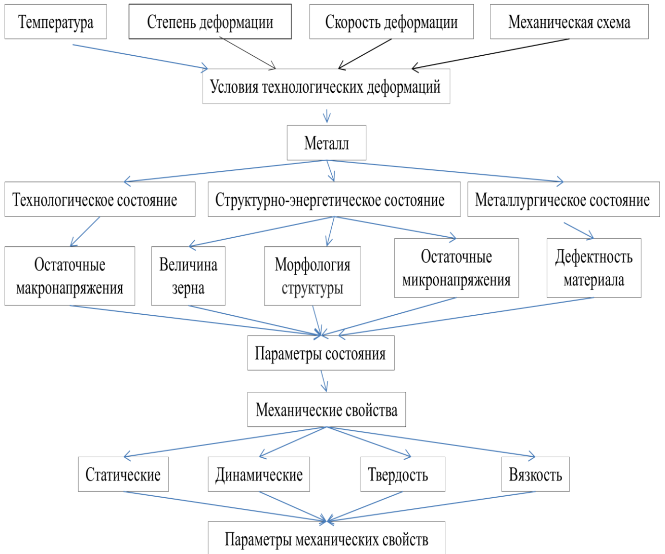
Рисунок 1.1 – Связь механических свойств с параметрами металлургического, структурно-энергетического и технологического состояний поликристаллических материалов
