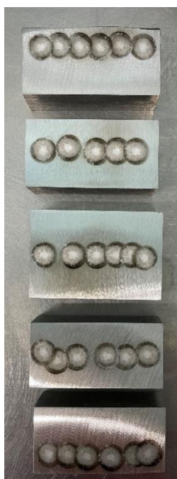
Рисунок 2.2 - «Прожиги» спектрального анализа по толщине сляба
