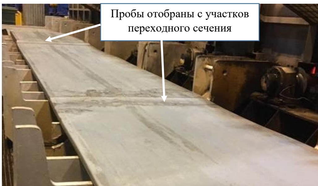
Рисунок 2.5 - Раскат после деформации в первой и второй черновых клетях
