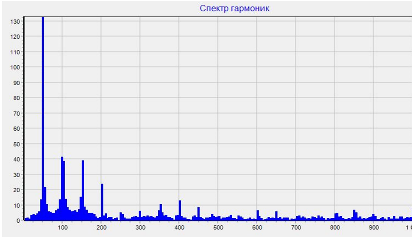
Рисунок 98 – ВГ напряжения мобильного ЭТК в режиме воспроизведения напряжения с частотой сигнала 50 Гц
