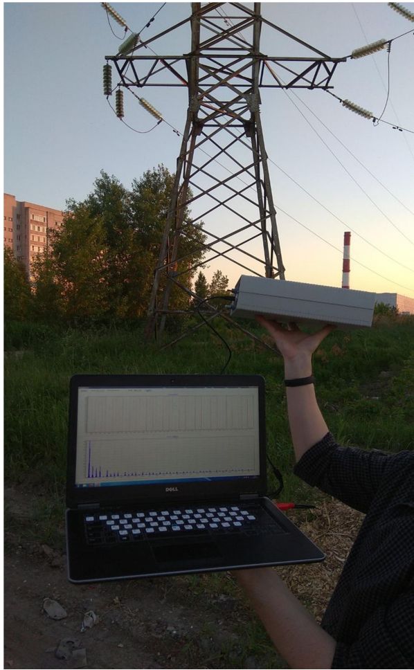
Рисунок 117 – Апробация комплекса мониторинга в условиях помех от ВЛ 110 кВ
