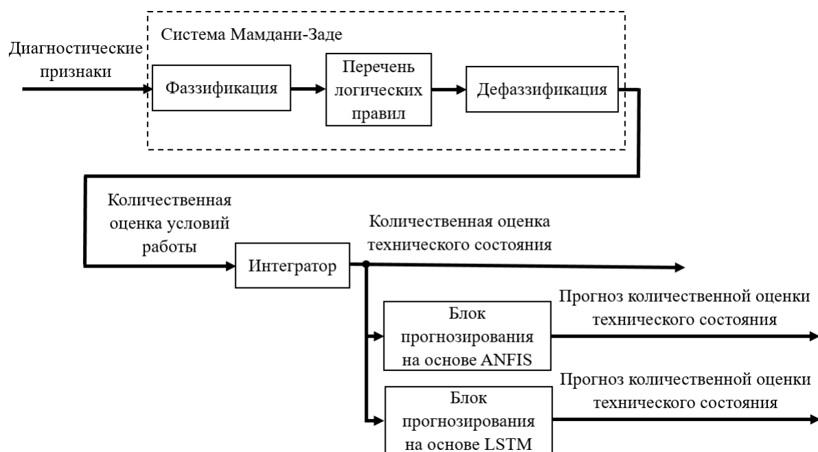
Рис. 4.1. Структурная схема системы количественной оценки технического состояния с блоками прогнозирования
