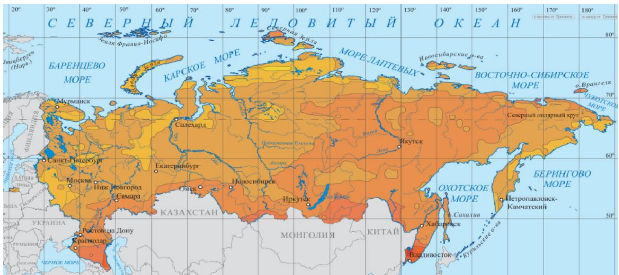
Рис. 1.1 – Средняя за год суточная сумма солнечной радиации, приходящей на поверхность с углом наклона, равным географической широте
