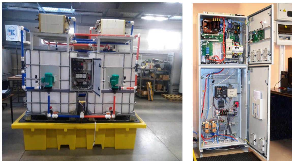
Рисунок 13 – Стенд проточного аккумулятора, зарядное устройство и система управления стендом
